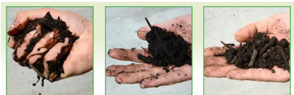
Figura 2.5. Prueba del puño. Izquierda: compost demasiado húmedo. Centro: compost con un contenido de humedad óptimo. Derecha: compost demasiado seco [24].
