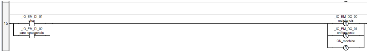
Figura 6.8. Función de paro de emergencia. Fuente: Elaboración propia.
