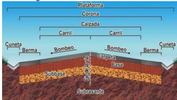
Figura 3. Sección típica de un pavimento flexible.
