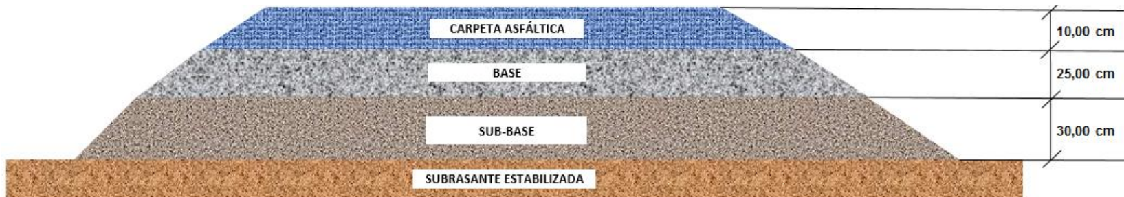
Figura 57. Configuración de las capas del pavimento flexible.
