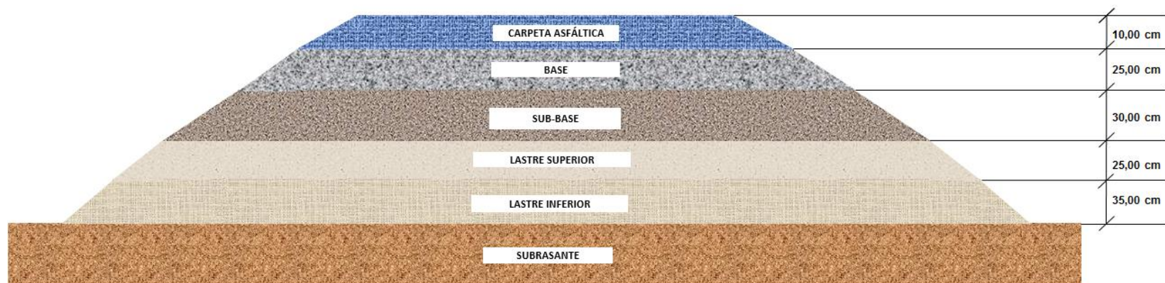
Figura 58. Configuración de las capas del pavimento flexible.
