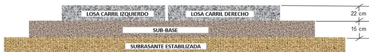
Figura 61. Configuración de las capas del pavimento rígido.
