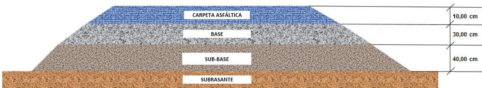
Figura 56. Configuración de las capas del pavimento flexible.
