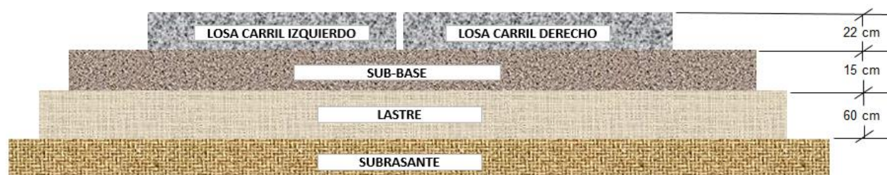
Figura 63. Configuración de las capas del pavimento rígido.
