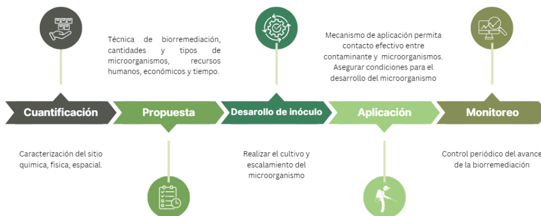
Fig 6. Proceso de biorremediación [45].
