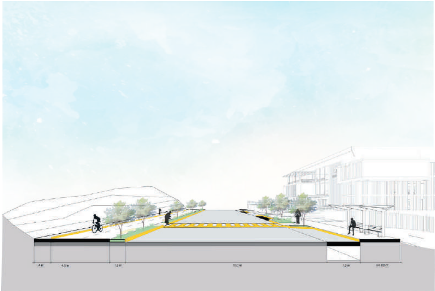
Figura 5.53: Sección de calle A-A' Elaboración propia
