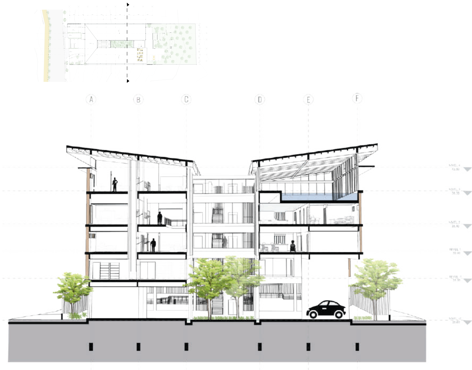
Figura 5.54: Sección transversal B_B' Elaboración propia
