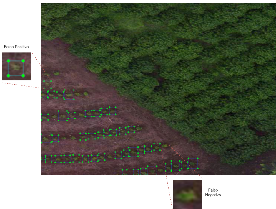
Figura 2.13: Resultado en imagen de prueba con resolución a 4 cm/píxel [5].
