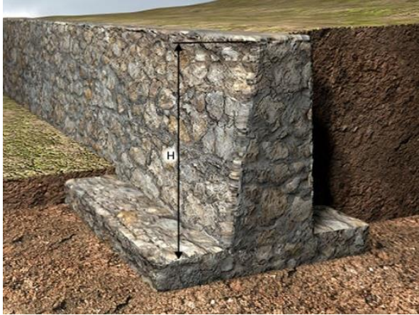
Figura 79. Concreto ciclopeo en un muro de contención (CYPE Ingenieros, s.f).
