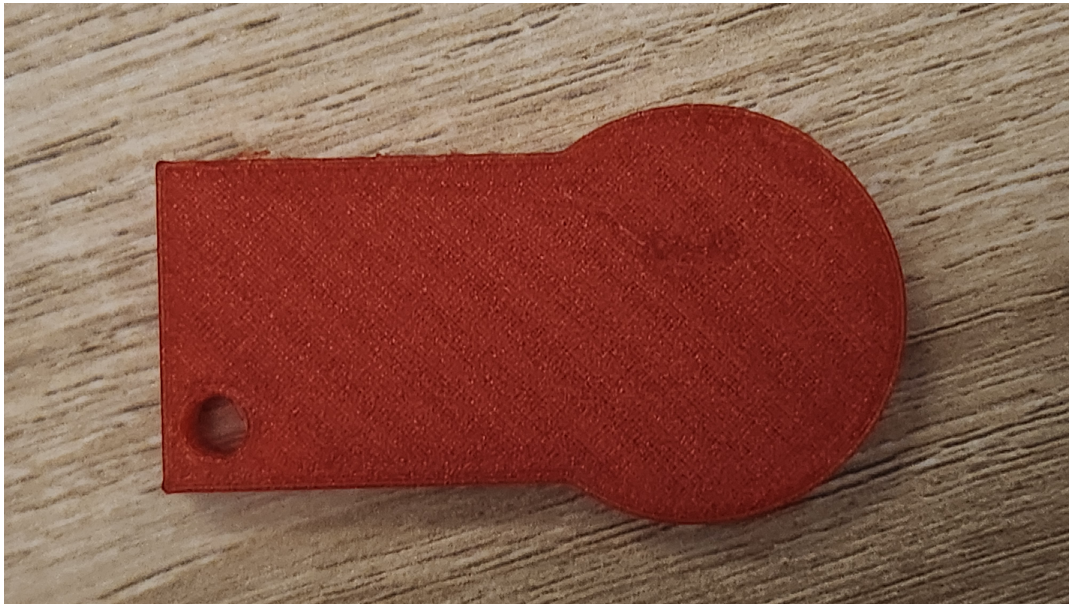
Figura 4.3: Agujero de tapa para saliente de cable
