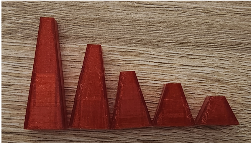
Figura 5.2: Calzas para aumento de diámetro para validación
