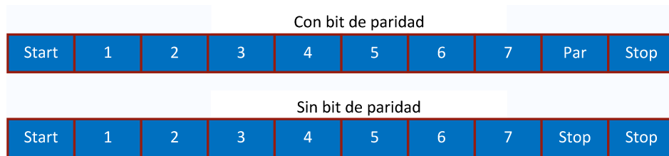
Figura 3.6: Formato de trama en la transmisión serie para modo ASCII [17]
