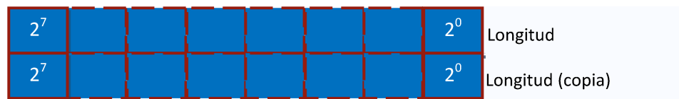
Figura 3.14: Campo longitud la ASDU para el protocolo IEC 870-5-101 [32]
