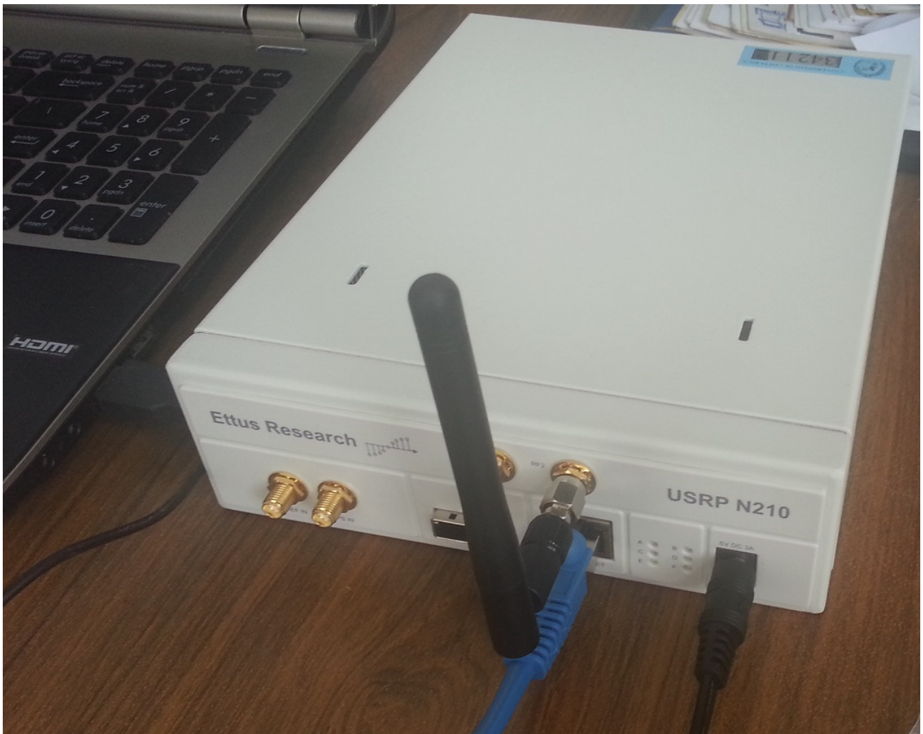
Figura 35: Sistema USRP con su respectiva antena, conectado a la computadora mediante Ethernet.
