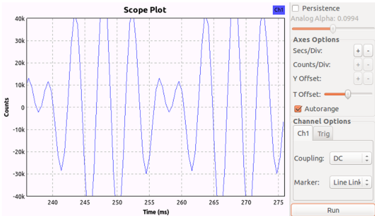
Figura 28: Salida de FIR en FPGA de Zedboard. Entrada suma de senoidales de 200 y 250 Hz respectivamente.
