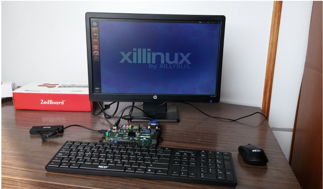
Figura 11: Sistema completo de ZedBoard ejecutando Xillinux con los respectivos periféricos.
