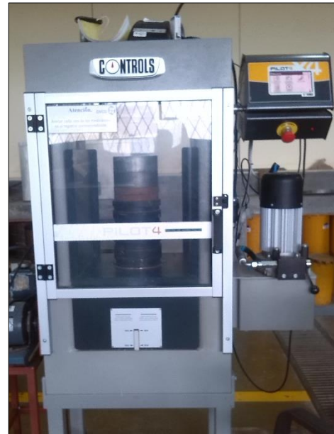
Figura 28. Máquina de fallas utilizada en el ensayo de resistencia a la compresión de cubos de mortero hidráulico.
