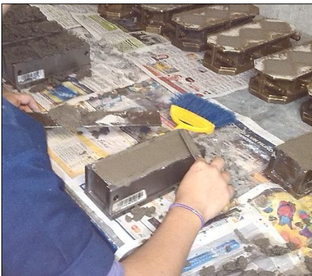
Figura 24. Nivelación de la segunda capa de mezcla de los especímenes para el ensayo de resistencia a la compresión de cubos de mortero hidráulico.
