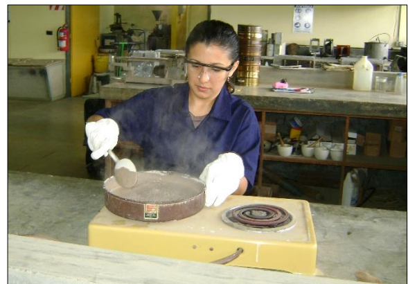
Figura 13. Secado de las muestras para el ensayo de gravedad específica y absorción.
