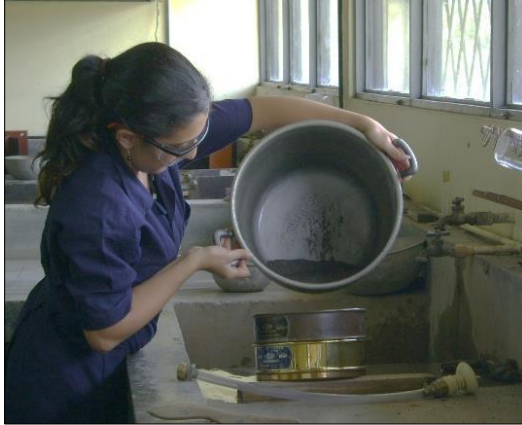
Figura 9. Lavado de material más fino que la malla N°200.
