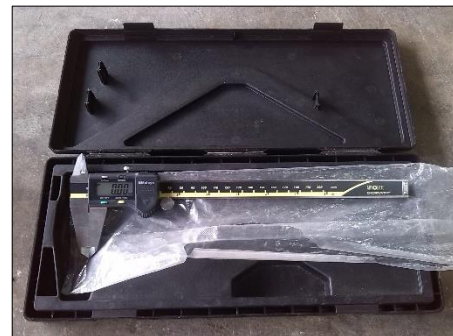
Figura 18. Calibrador vernier utilizado en la medición de los moldes previo al moldeo de cubos de mortero.
