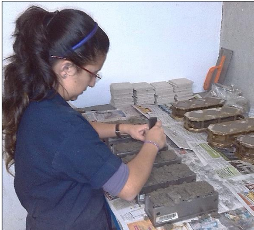
Figura 23. Apisonamiento de la segunda capa de mezcla de los especímenes para el ensayo de resistencia a la compresión de cubos de mortero hidráulico.
