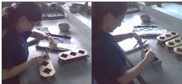
Figura 19. Medición de los moldes previo al moldeo de cubos de mortero.
