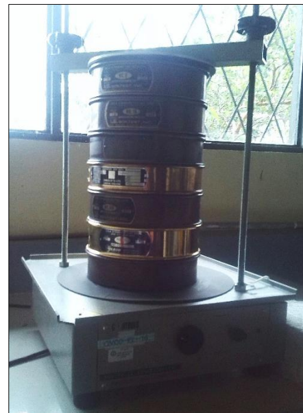
Figura 10. Tamizadora eléctrica utilizada en el ensayo de granulometría para agitar las mallas.
