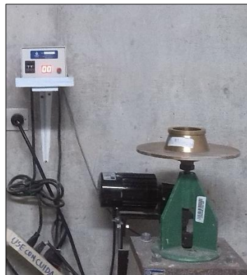
Figura 20. Mesa de flujo mecánica utilizada en el ensayo para el cálculo del flujo del mortero hidráulico.
