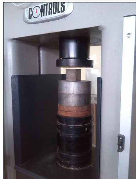
Figura 29. Colocación de la muestra en la máquina de fallas para el ensayo de resistencia a la compresión de cubos de mortero hidráulico.
