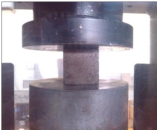
Figura 30. Aplicación de la carga a la muestra en la máquina de fallas para el ensayo de resistencia a la compresión de cubos de mortero hidráulico.
