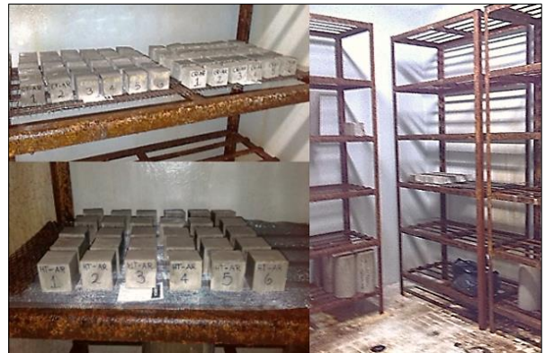
Figura 26. Cubos de mortero en la cámara húmeda para el ensayo de resistencia a la compresión de cubos de mortero hidráulico.
