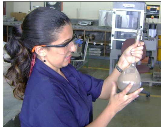
Figura 16. Reducción de burbujas para el ensayo de gravedad específica y absorción.
