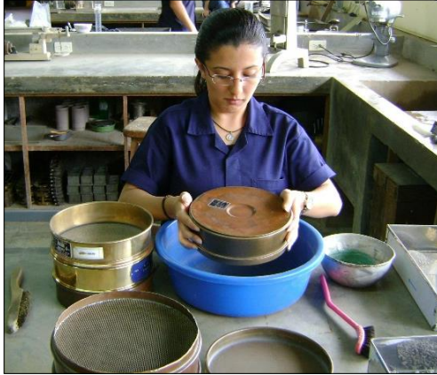
Figura 11. Tamizado manual para el ensayo de granulometría.
