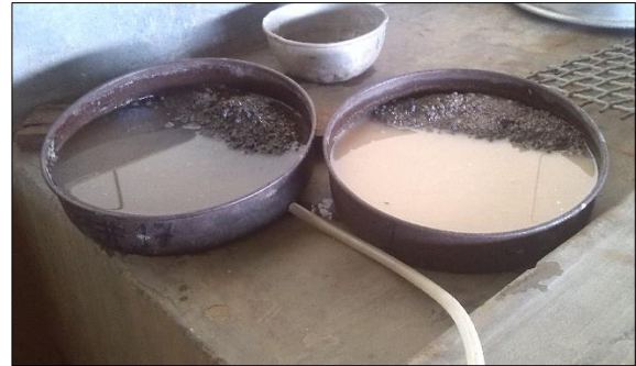
Figura 12. Decantado del exceso de agua para el ensayo de gravedad específica y absorción.
