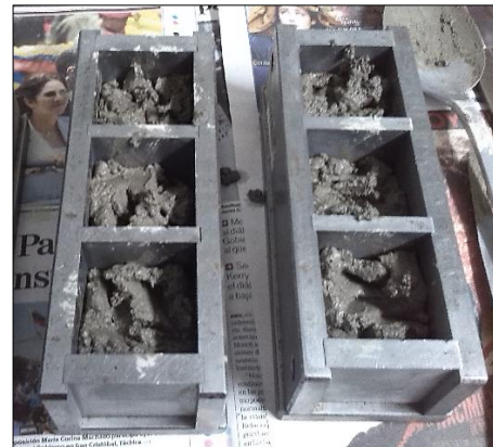
Figura 21. Colocación de la primera capa de mezcla para ser apisonada.
