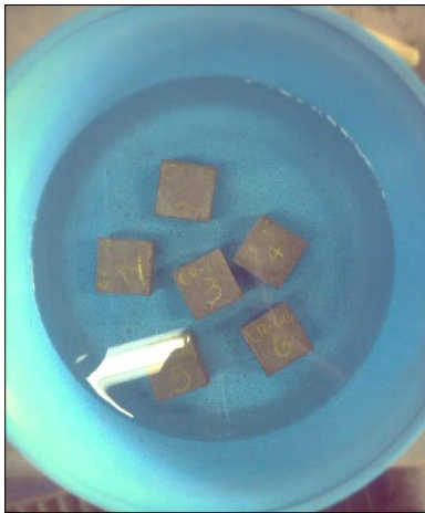
Figura 27. Cubos de mortero sumergidos en agua, previo a ser fallados en el ensayo de resistencia a la compresión de cubos de mortero hidráulico.
