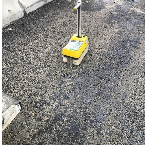
Figura 17. Compactación en campo con densímetro nuclear
