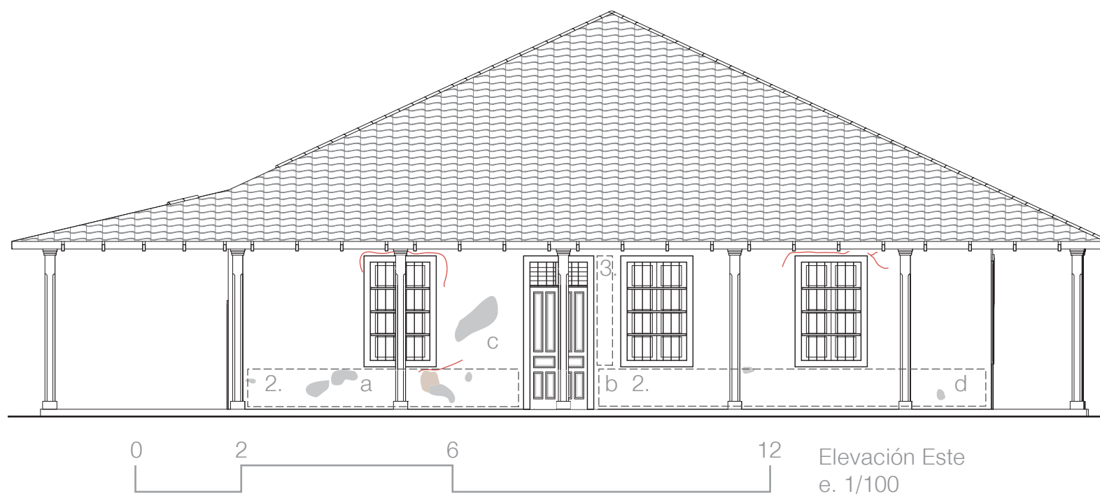
1. Área de descamación del acabado de la pintura
