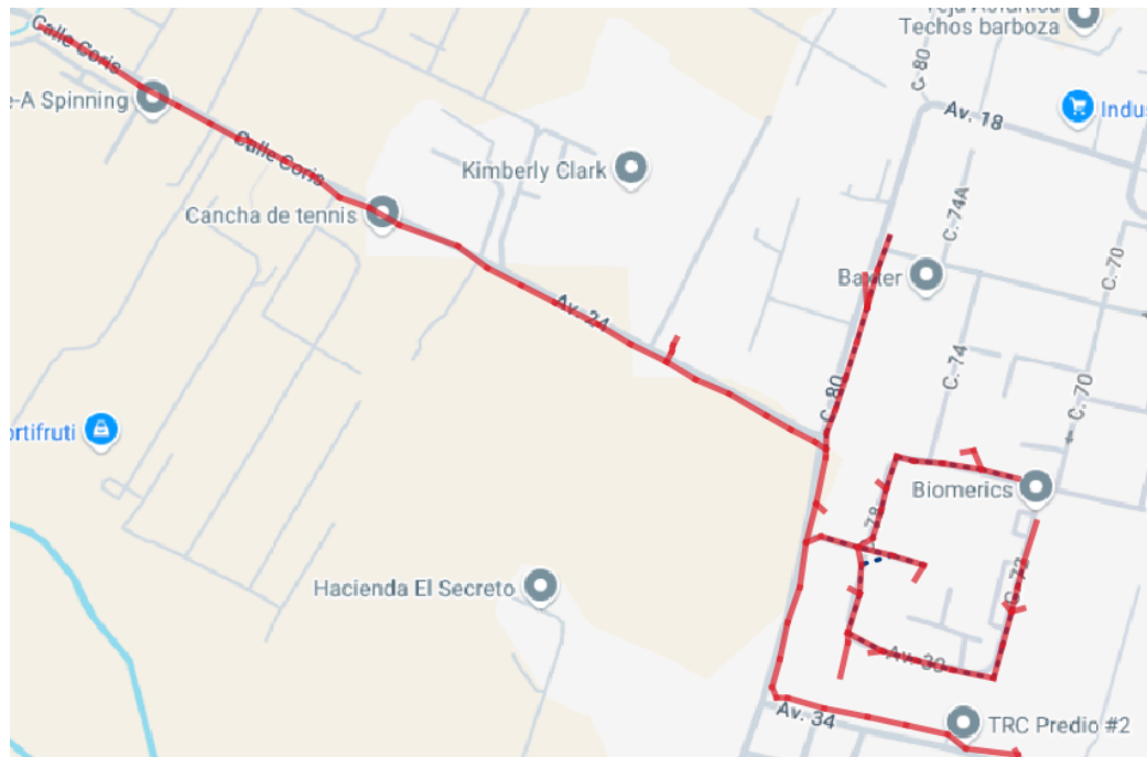
Figura 3.7: Representación espacial de la red primaria en media tensión (MT). Fuente: Elaboración propia por medio de QGIS.
