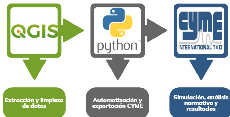
Figura 2.2: Esquema conceptual del flujo de datos para la construcción automatizada de modelos eléctricos. Fuente: Elaboración propia.
