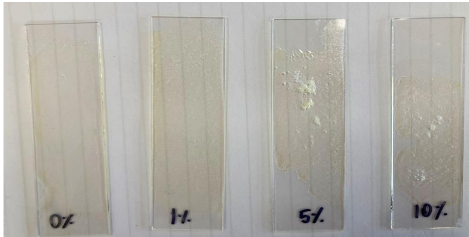
Figura 3.1. Vidrios portaobjetos recubiertos con sustancia a base de VO 2 (concentraciones desde 0% hasta 10%), resultado de pruebas en laboratorio. Fuente: Elaboración propia.
