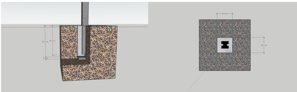
Figura 24. Modelado de cimentación para columnas prefabricadas.
