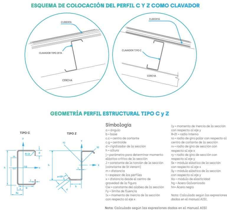
Figura 11. Detalles del Perfil C y Perfil Z presentes en la ficha técnica.
