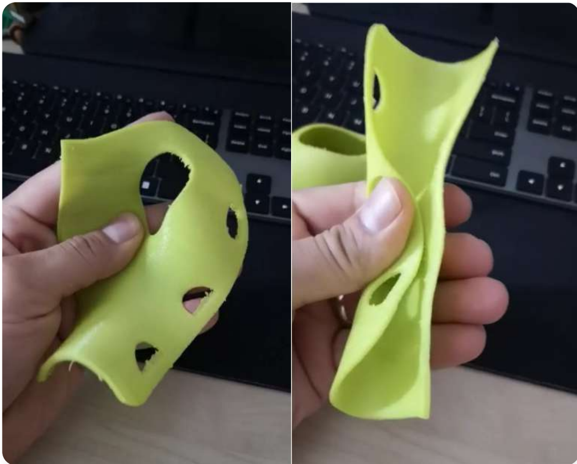
Fig. 51. Prototipo de Impresión 3D de las partes rígidas en FLEX.
