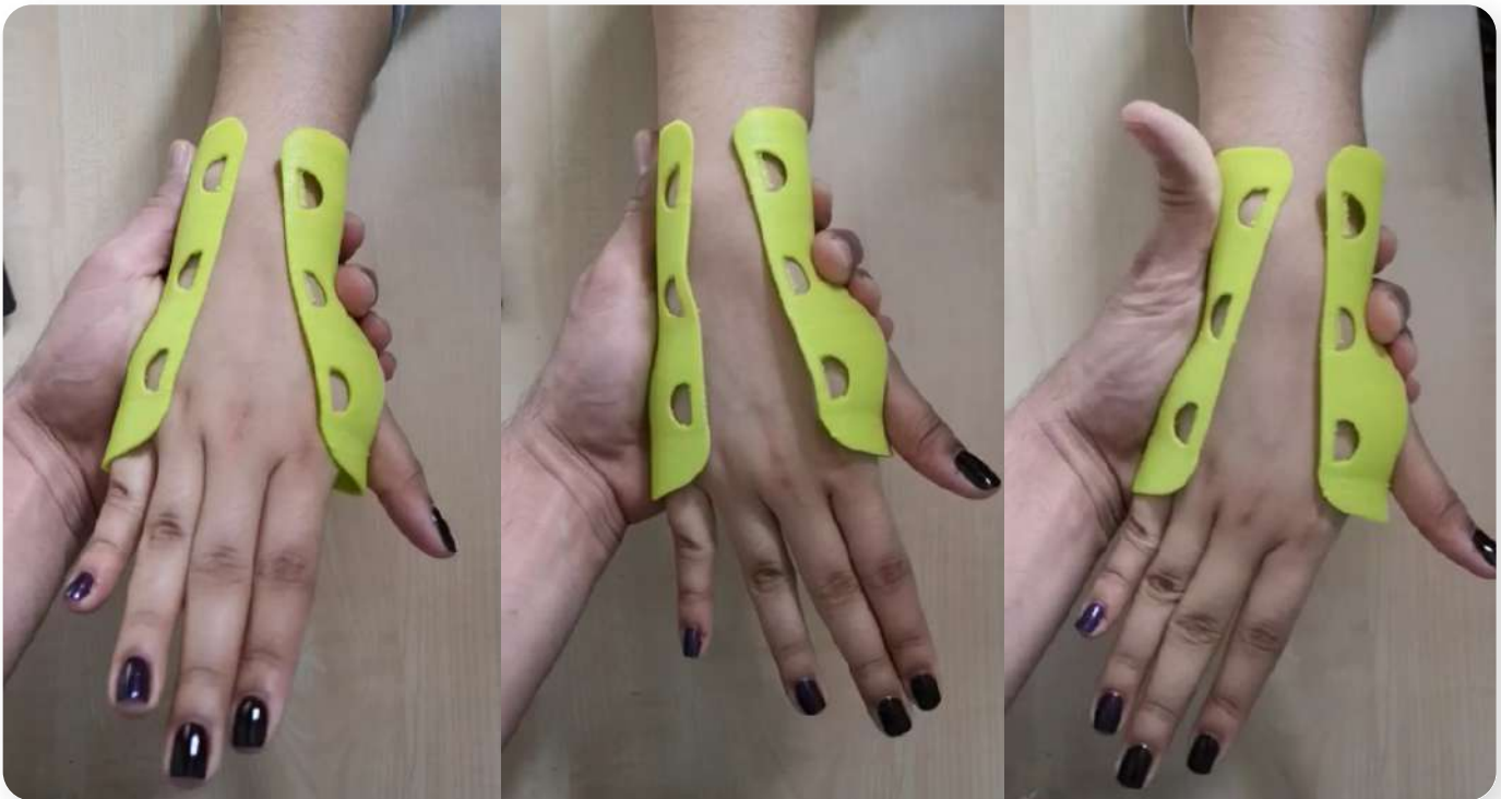
Fig. 52. Prueba del segundo prototipo impreso en 3D. Fuente: Elaboración propia, 2021.
