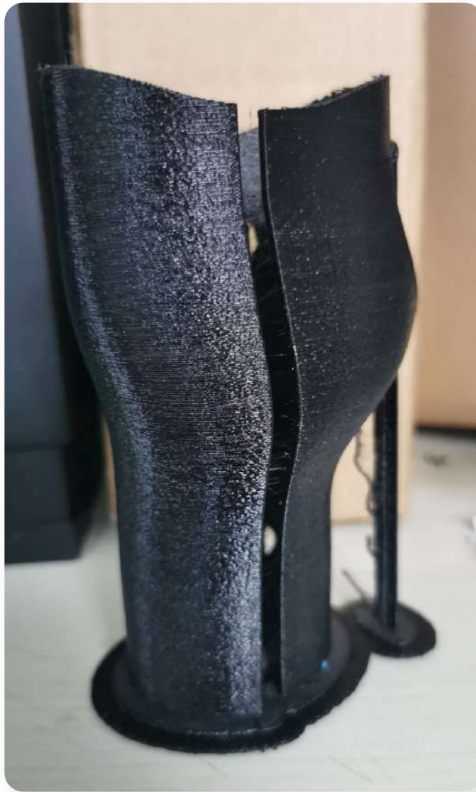
Fig. 48. Prototipo de Impresión 3D de las partes rígidas en ABS. Fuente: Elaboración propia, 2021.
