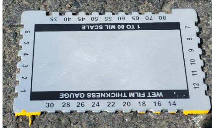
Figura 39 Medición de espesor de pintura base solvente el 03 de agosto, 2024 Barrio María Auxiliadora.
