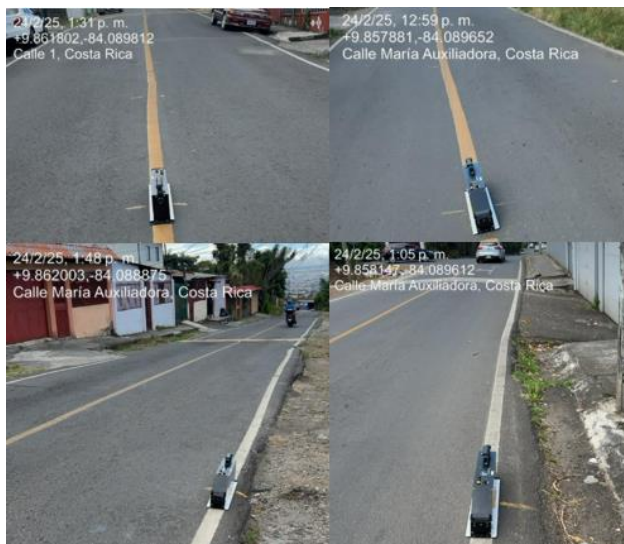
Figura 30 Medición de retroreflectividad del 24 de febrero del 2025, en paños de prueba varios
