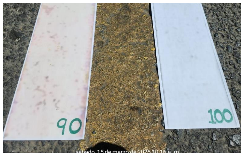
Figura 107 Desprendimiento pintura plástico en frío, el día 6/10/2024
