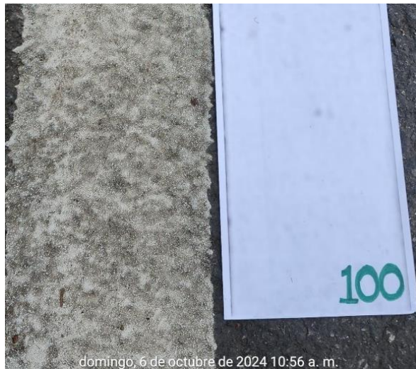
Figura 75 Desprendimiento pintura plástico en frío, el día 6/10/2024
