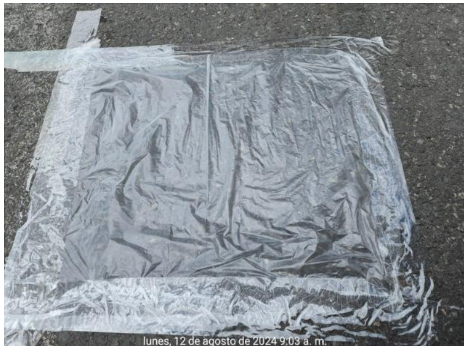
Figura 42 Medición de humedad previo demarcaciones.
