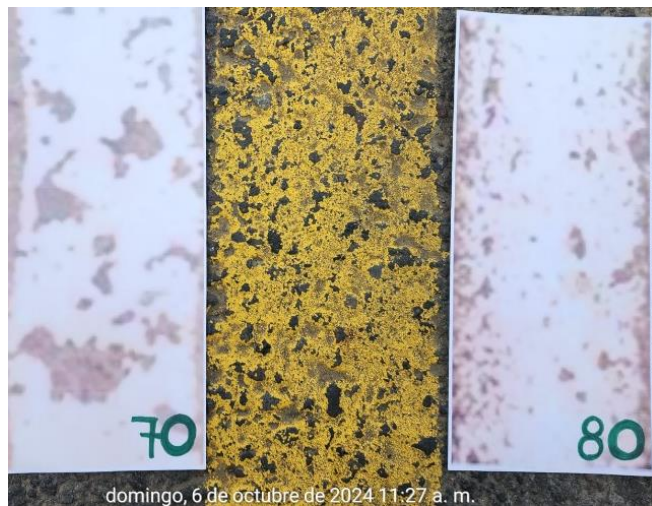
Figura 121 Desprendimiento de pintura solvente, el día 6/10/2024
