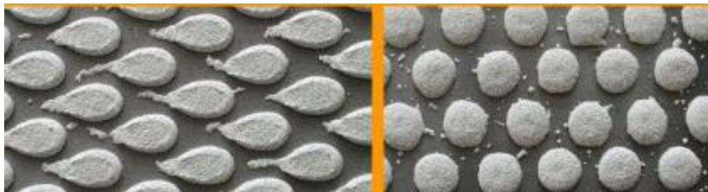
Figura 3 Marcaje perfilado con extrusión, pintura plástica en frío
