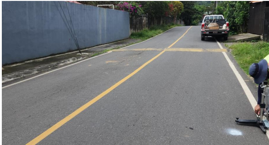
Figura 141 Medición de la resistencia al deslizamiento con péndulo británico .Barrio San Francisco Material Termoplástico
