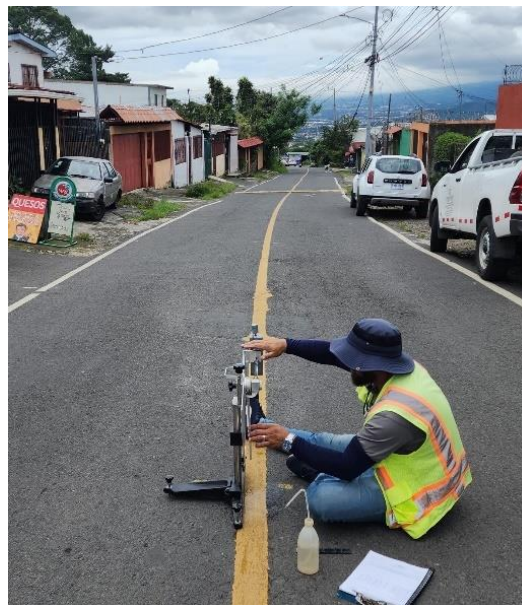
Figura 141 Medición de la resistencia al deslizamiento con péndulo británico .Barrio San Francisco Material Termoplástico
