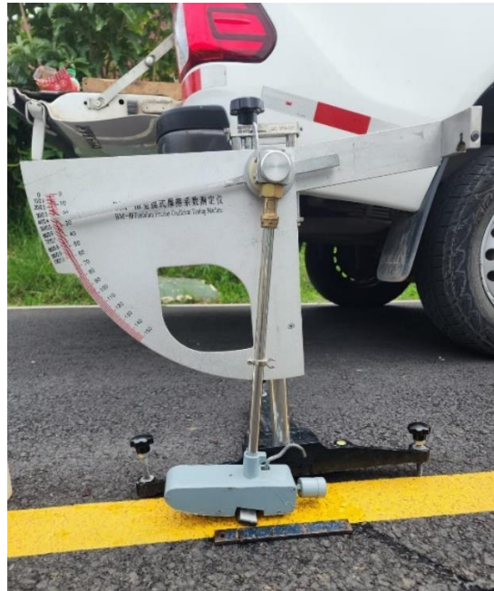
Figura 137 Medición de la resistencia al deslizamiento con péndulo británico
