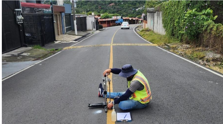
Figura 139 Medición de la resistencia al deslizamiento con péndulo británico. Barrio El Socorro Plástico en Frio
