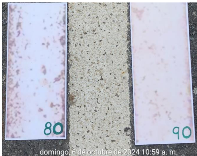
Figura 77 Desprendimiento de pintura solvente, el día 6/10/2024
