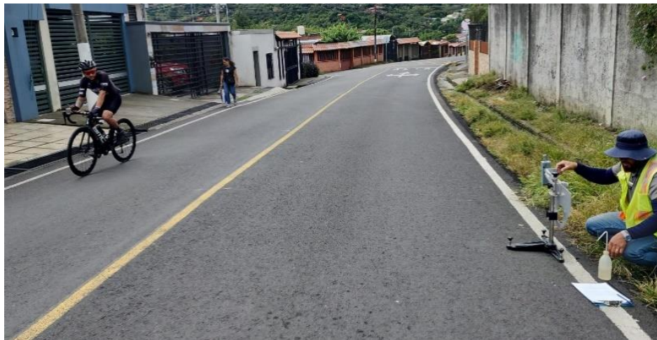
Figura 138 Medición de la resistencia al deslizamiento con péndulo británico, Barrio El Socorro. Plástico en Frio
