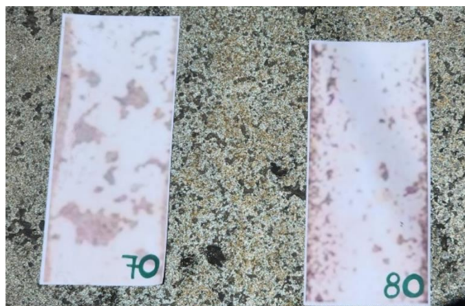
Figura 65 Desprendimiento de pintura solvente, el día 6/10/2024
