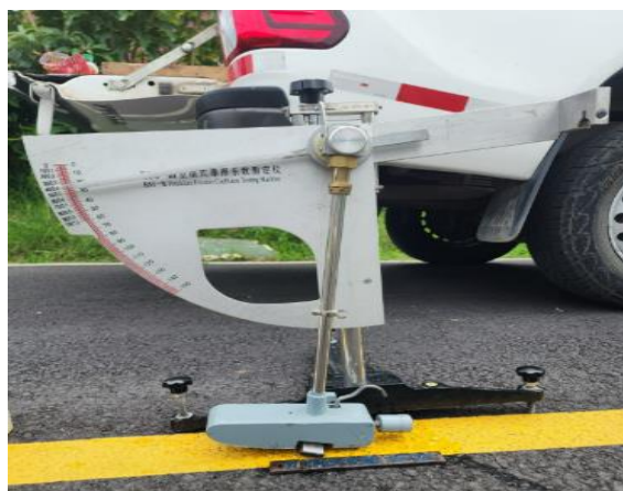
Figura 16 Péndulo británico, herramienta para medir fricción de superficies
