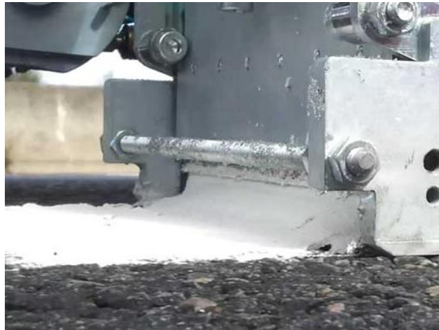
Figura 4 Aplicación de pintura plástico en frío por extrusión Fuente: página oficial empresa la empresa Hofmann
