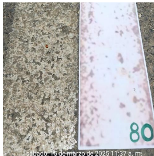
Figura 77 Desprendimiento de pintura solvente, el día 6/10/2024
