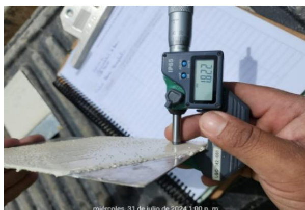
Figura 37 Medición de espesor de material termoplástico el 31 de julio, 2024 Barrio San Francisco
