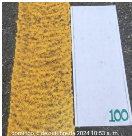
Figura 69 Desprendimiento de plástico en frío, el día 6/10/2024
