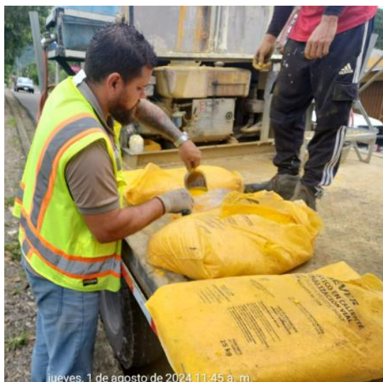
Figura 43 Muestro de material termoplástico amarillo
