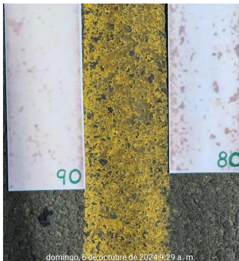
Figura 109 Desprendimiento de pintura solvente, el día 6/10/2024
