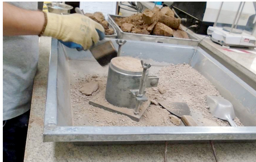
Imagen 39. Ejecución de prueba proctor. Fuente: Vieto Ingenieros Consultores.
