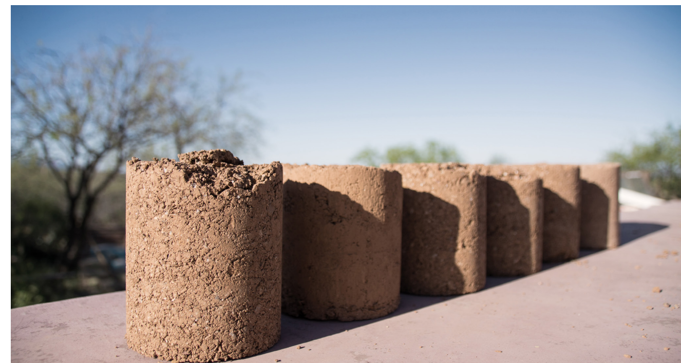
Imagen 37. Prueba proctor durante taller de construcción con tapial. Fuente: propia.
