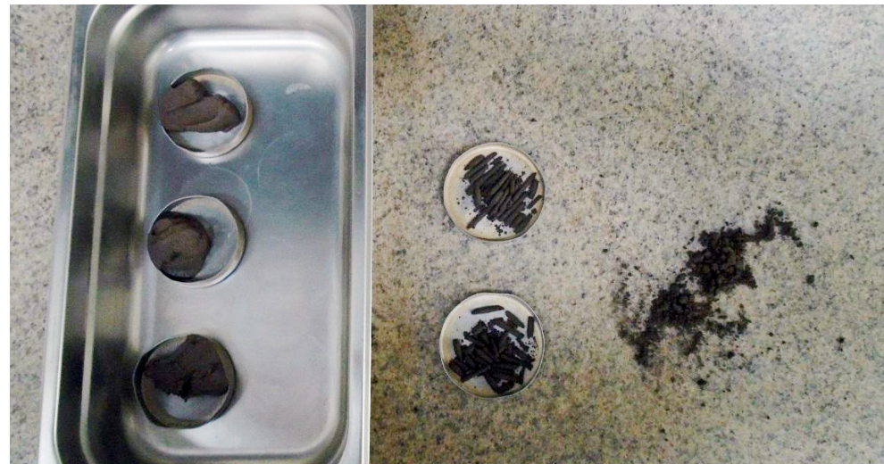
Imagen 40. ejecución de de plasticidad. Fuente: Vieto Ingenieros Consultores.
