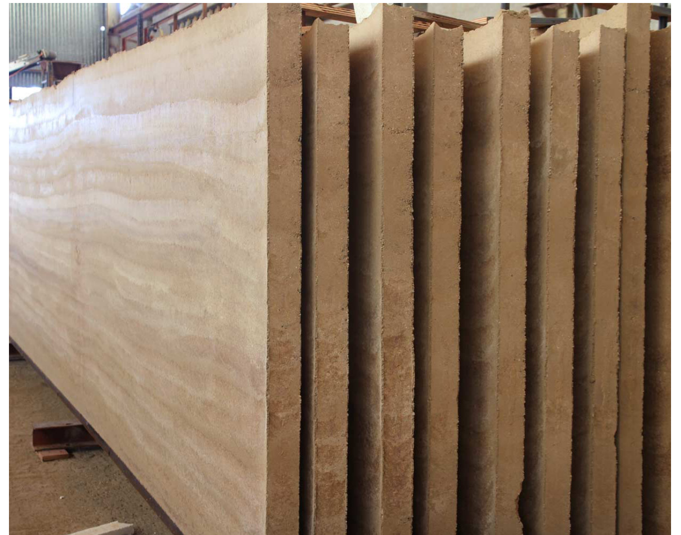
Imagen 49. Muros prefabricados en tapial. Fuente: Rammed Earth Works.
