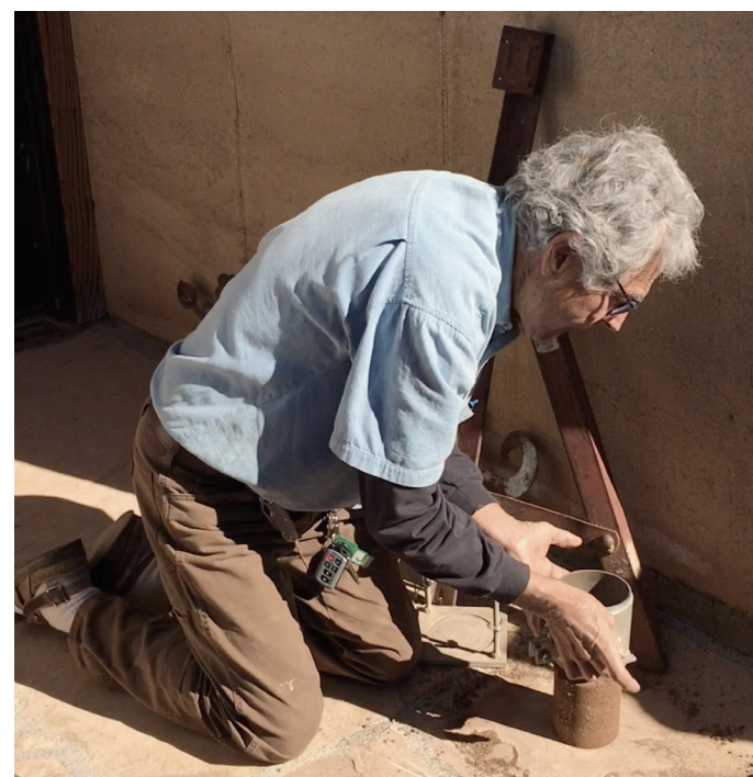
Imagen 36. Ejecución de prueba proctor. Fuente: propia.
