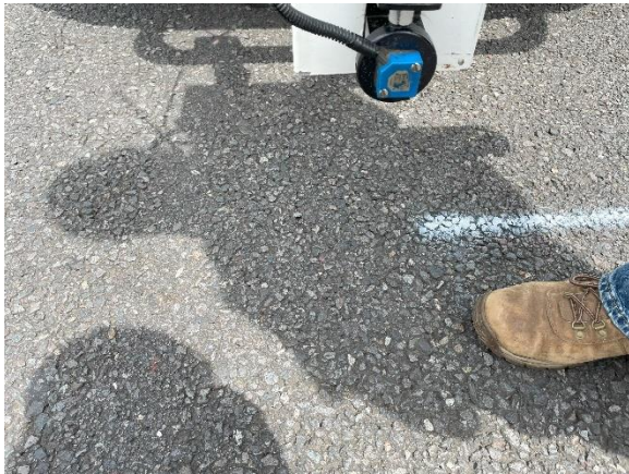
Figura 73. Proyección láser perfilómetro inercial
