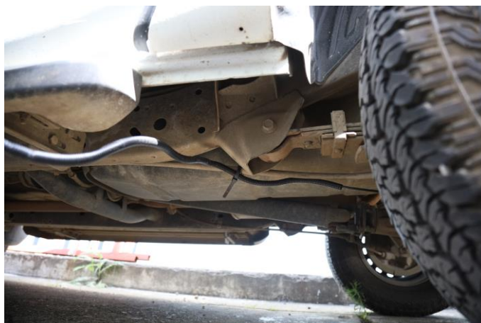
Figura 7. Ejemplo de sujeción del cable del acelerómetro al ducto de líquido de frenos.
