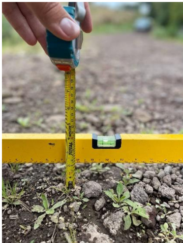
Figura 38. Profundidad bache 1 UM-02 Jaules 18/10
