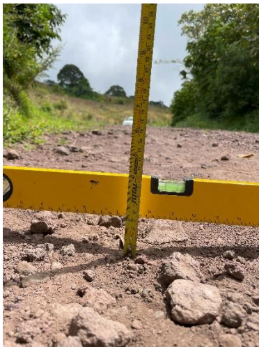
Figura 25. Profundidad bache 1 UM-02 Jaules 04/10
