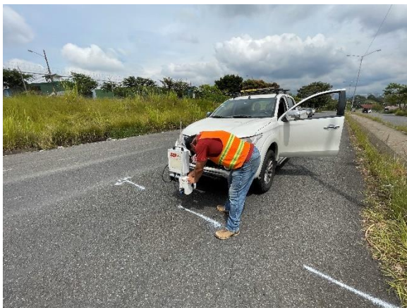
Figura 74. Ubicación del láser en la huella izquierda
