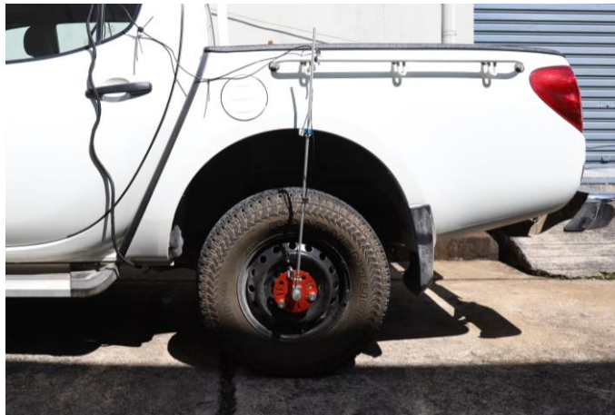
Figura 9. DMI instalado en vehículo tipo pick up.
