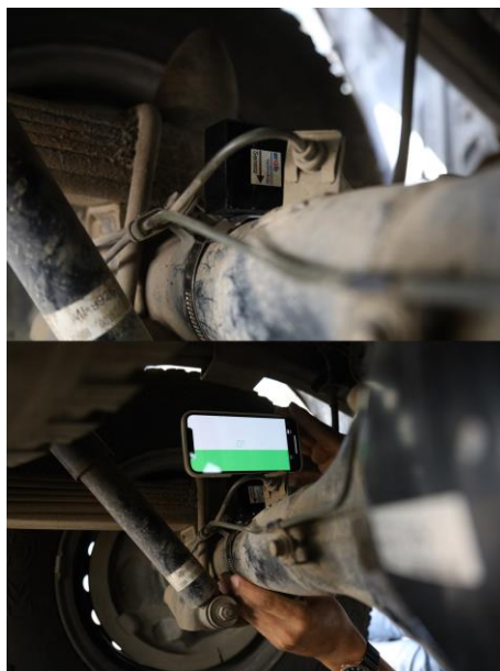
Figura 6. Montaje del acelerómetro en un eje rígido.
