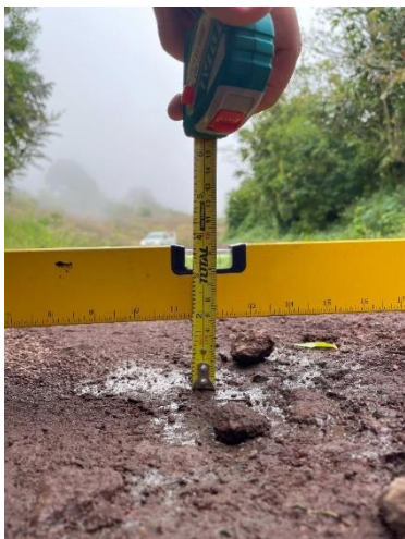
Figura 81. Profundidad bache 1 UM-02 Jaules 15/11
