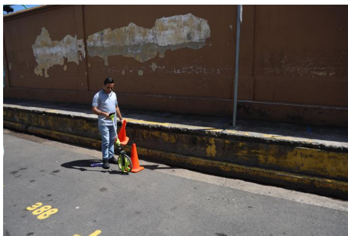
Figura 17. Delimitación de los puntos inicial y final de la pista de medición para la calibración del DMI.
