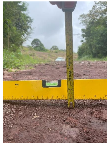
Figura 64. Profundidad bache 1 UM-02 Jaules 01/11
