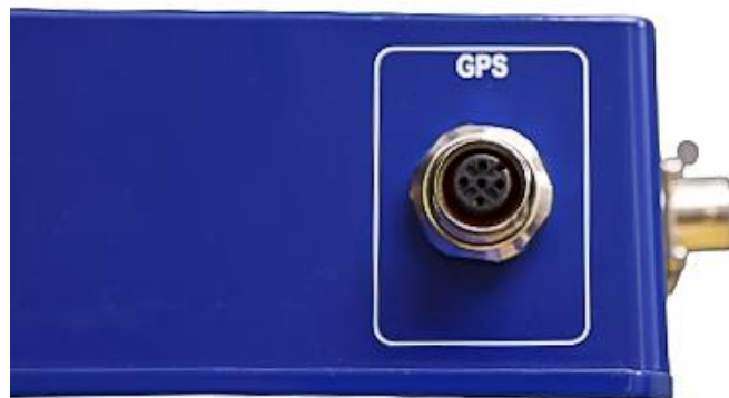
Figura 14. Puerto de conexión receptor GPS en el módulo de interfaz.
