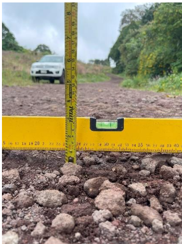
Figura 67. Profundidad bache 3 UM-02 Jaules 01/11
