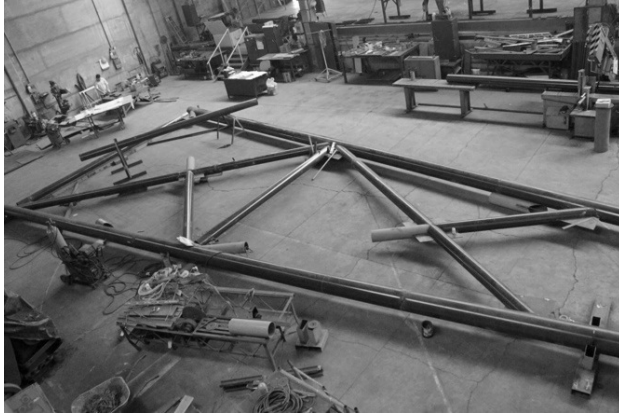
Figura 9. Plantilla de marco a escala natural Fuente: elaboración propia
