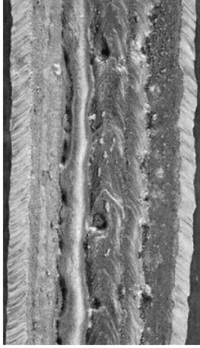
(b) Concavidad en soldadura
