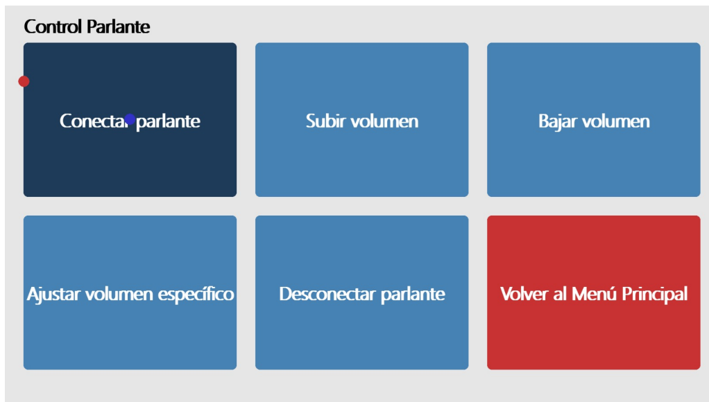
Figura 3.7: Interfaz de control del parlante Bluetooth. Permite la conexión, desconexión y ajuste del volumen mediante botones grandes.
