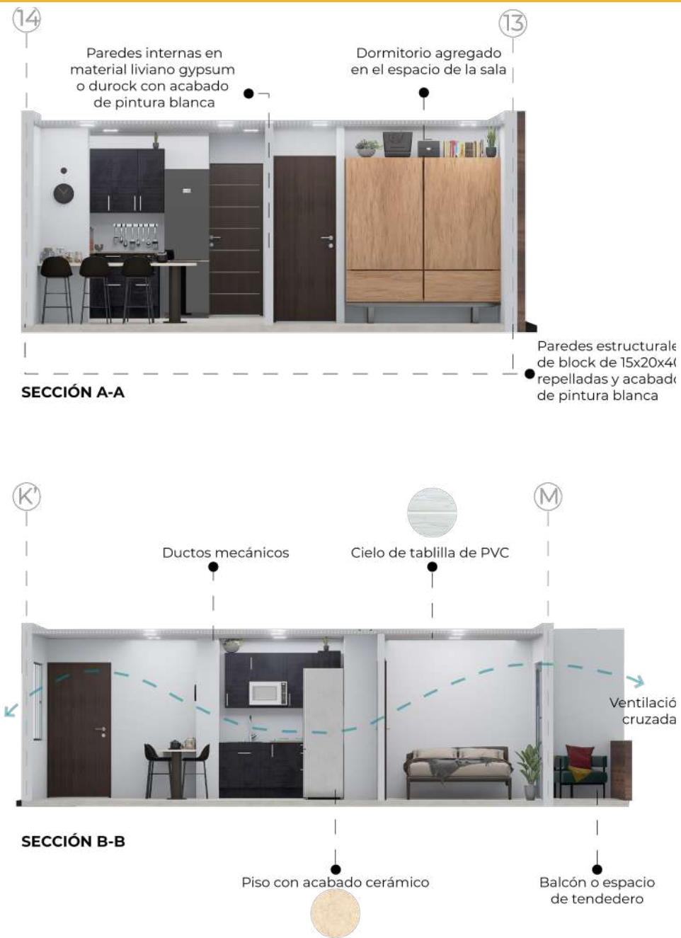
Figura 151: Secciones vivienda 42m2 completa.
