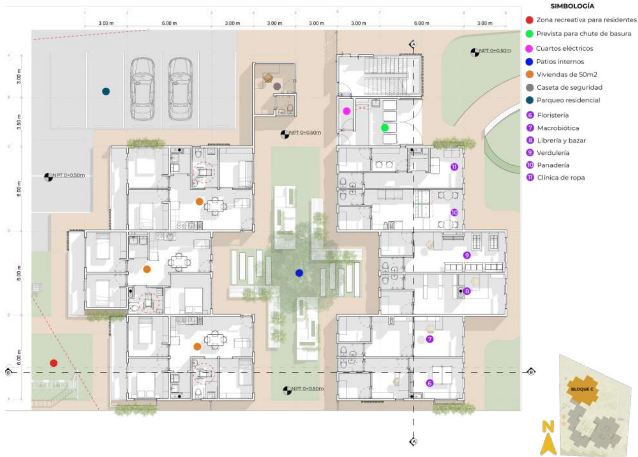
Figura 121: Planta de distribución arquitectónica nivel 1 - Bloque C.
