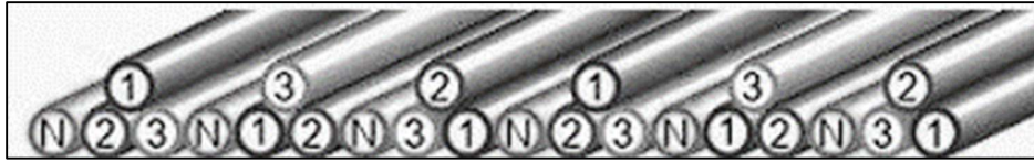
Figura 38. Ejemplo de distribución de cableado en canasta metálica.
