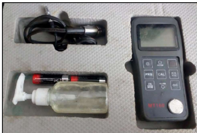
Figura 24. Medidor de espesor ultrasónico MT160 utilizado en pruebas a la estructura en estudio.
