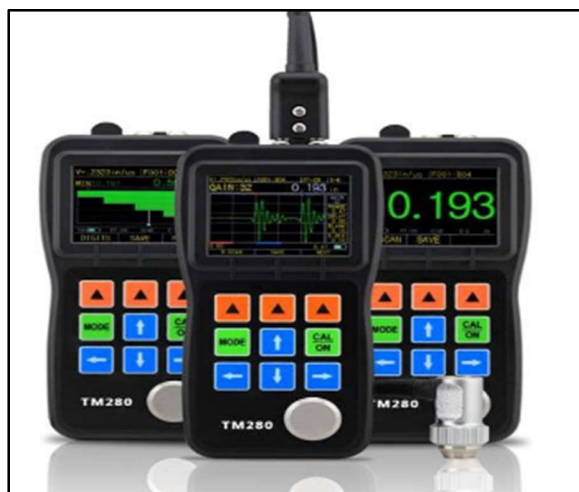
Figura 25. Medidor de espesor ultrasónico TM280 utilizado en pruebas a la estructura en estudio.
