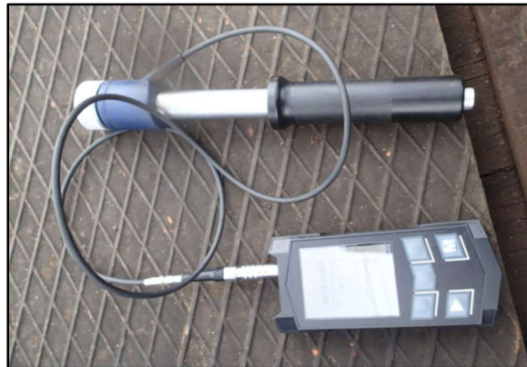
Figura 26. Durómetro KT-C con sonda de tipo G.
