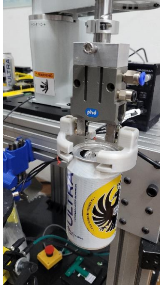
Figura 5-3: Sujeción de lata de cerveza vacía por medio de gripper y uñas presentes en el laboratorio de Kopar.
