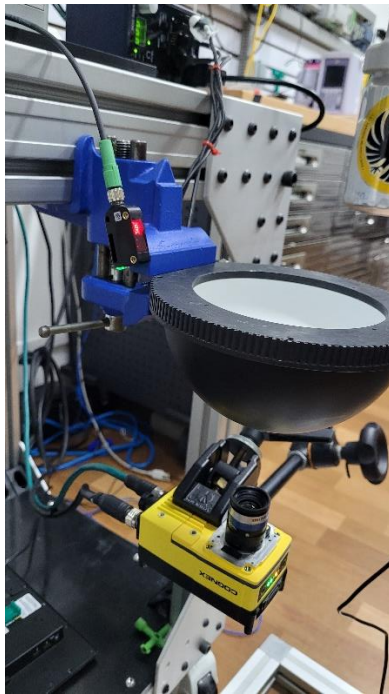
Figura 5-4: Método de sujeción y colocación de la cámara, el domo y el sensor fotoeléctrico auto reflectivo.
