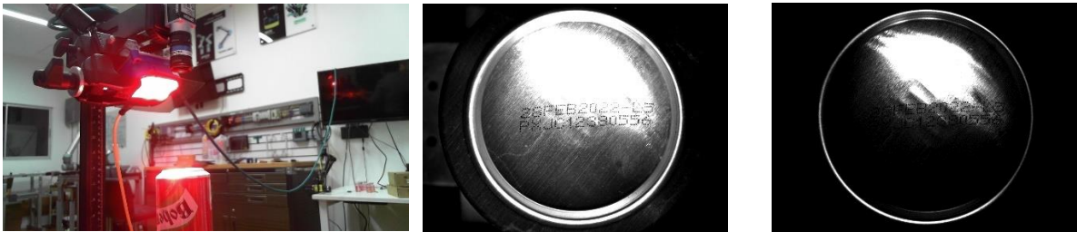
Figura 4-25: Pruebas de iluminación con luz spot. a) Montaje, b) Mejor imagen capturada sin polarizador y c) mejor imagen capturada con polarizador.
