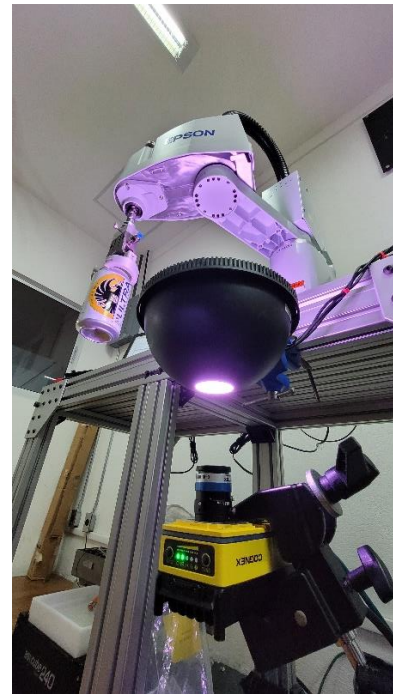
Figura 5-4: Método de sujeción y colocación de la cámara, el domo y el sensor fotoeléctrico auto reflectivo.
