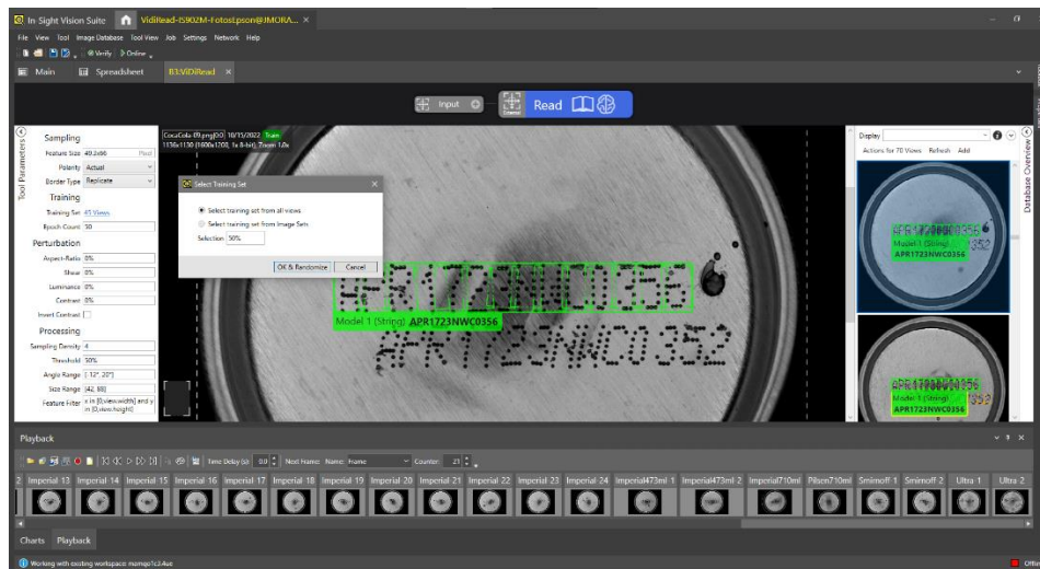
Figura B-6: Paso 6 para el entrenamiento de lectura de caracteres por medio de ViDi Read y Aprendizaje Profundo.
