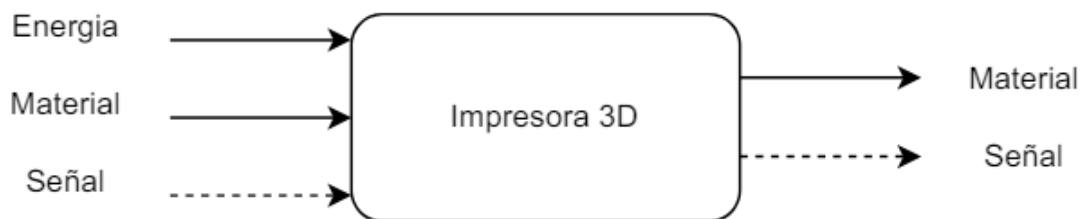
Figura 4-4 Descomposición Funcional Primaria de una impresora 3D
