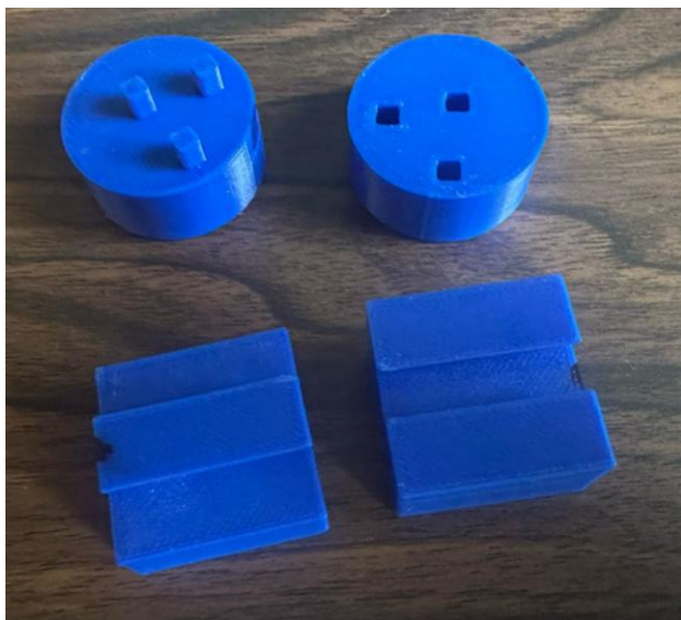
Figura 4-31 Verificación Visual de una Correcta Impresión
