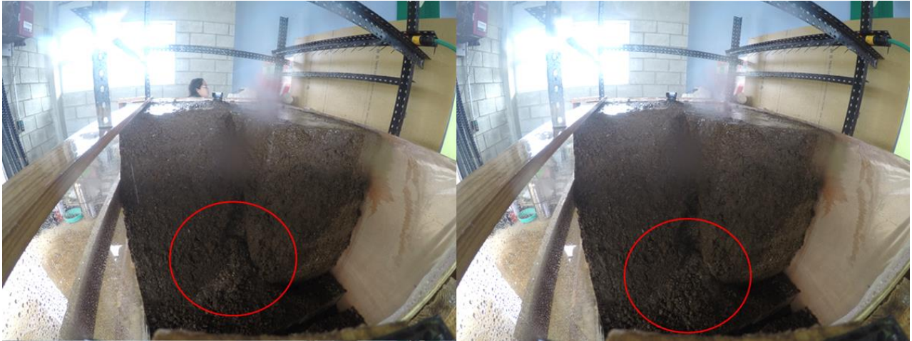
Figura 76. Movimiento tipo flujo observado en el talud con pendiente de 60°.
