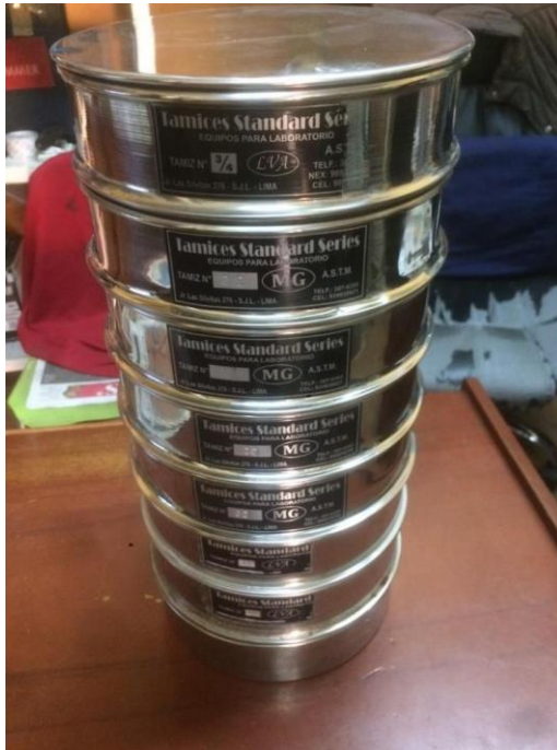
Figura 33 Batería de tamices utilizados en el ensayo ASTM D1140.
