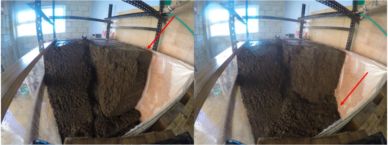
Figura 78. Mayor desprendimiento observado en el talud de pendiente 90°.
