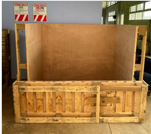
Figura 49. Estructura principal forrada con láminas de Plywood.
