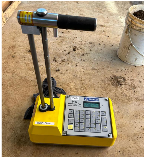
Figura 54. Densímetro nuclear 3450 RoadReader™ Plus.
