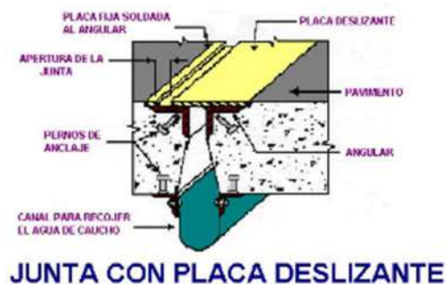
Figura 23. Esquema de juntas de placas de acero deslizante.
