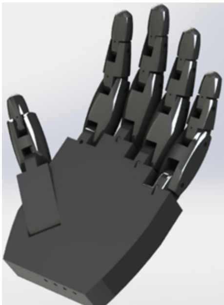
Figura 11. Propuesta de mano protésica mioeléctrica para utilización de teclado impresa en 3D.
