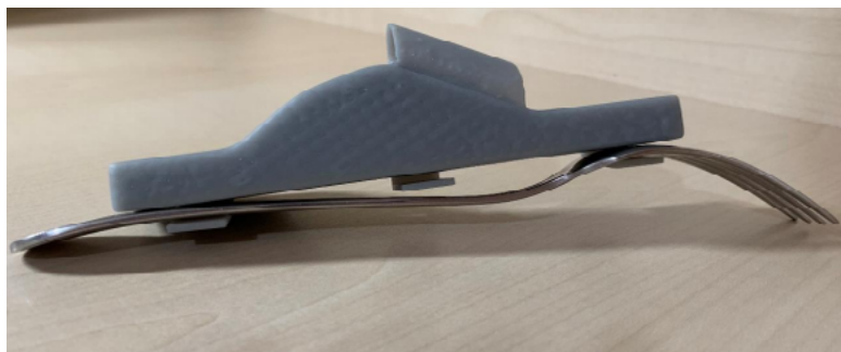
Figura 9. Ayuda técnica específica para uso de cubiertos para una persona con malformación congénita de mano.
