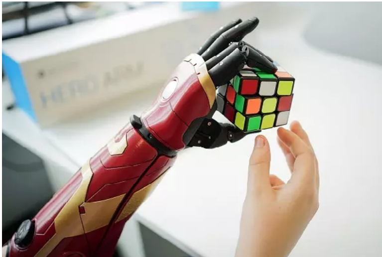
Figura 7. Mano biónica Hero Arm Fuente: [12]
