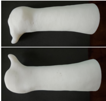
Figura 27. Impresión 3D del modelo del miembro superior izquierdo del usuario obtenido por medio de escaneo.
