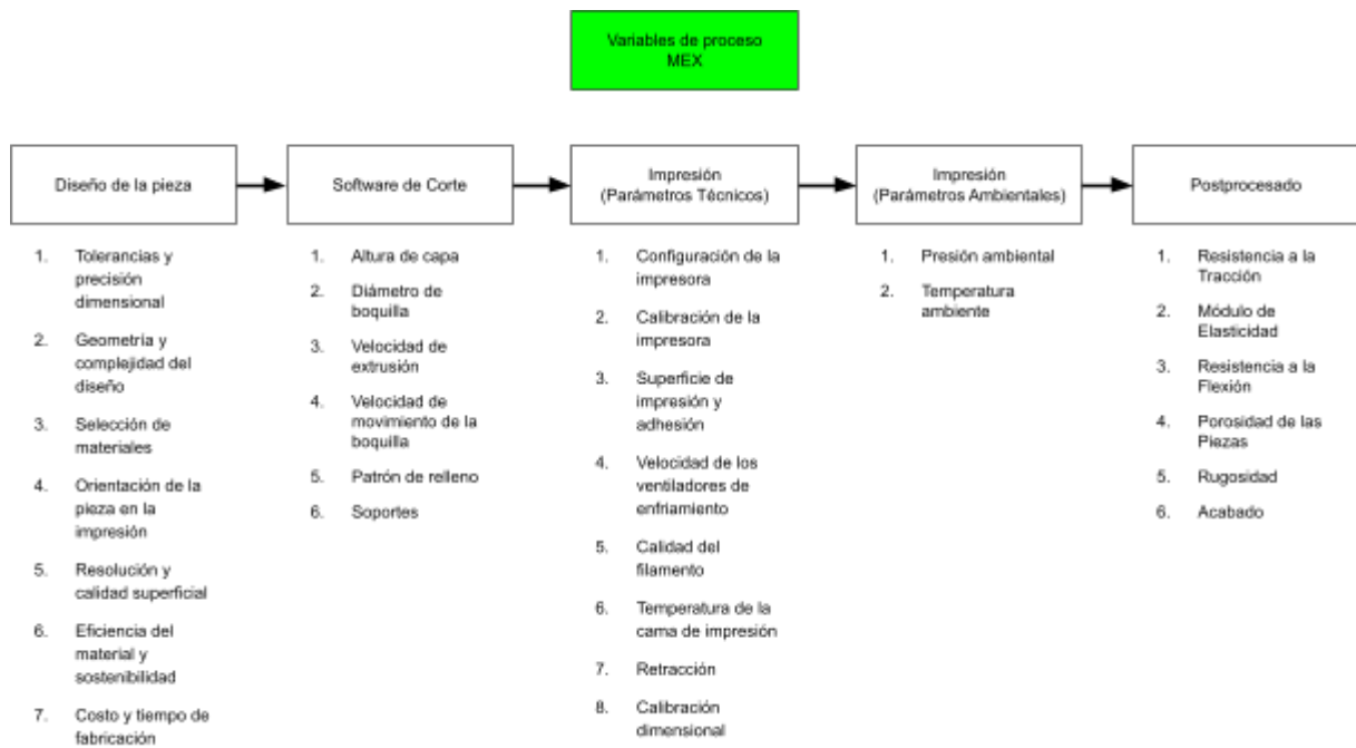
Figura No. 2. Cuadro resumen de las variables que afectan el proceso de fabricación mediante la tecnología MEX.
