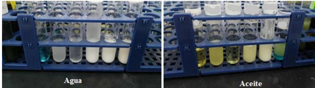
FIGURA 10 PRUEBAS DE SOLUBILIDAD EN AGUA Y ACEITE PARA SURFACTANTES COMERCIAL
