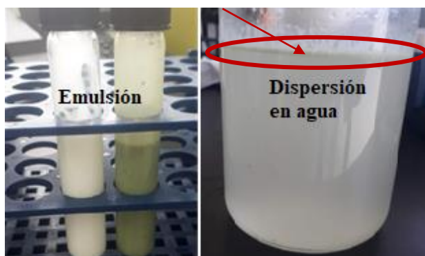
FIGURA 4 FORMULACIÓN DE EMULSIÓN CON MUESTRAS HÚMEDA. A) LA MANO IZQUIERDA ESTÁ A EMULSIÓN ESTABLE SIN MICROALGAS Y A LA DERECHA CON MICROALGAS; B) DISPERSIÓN DE 1 ML EMULSIÓN EN 500 ML DE AGUA.
