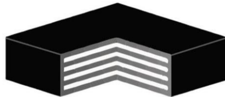
Figura 17. Apoyo de neopreno reforzado
