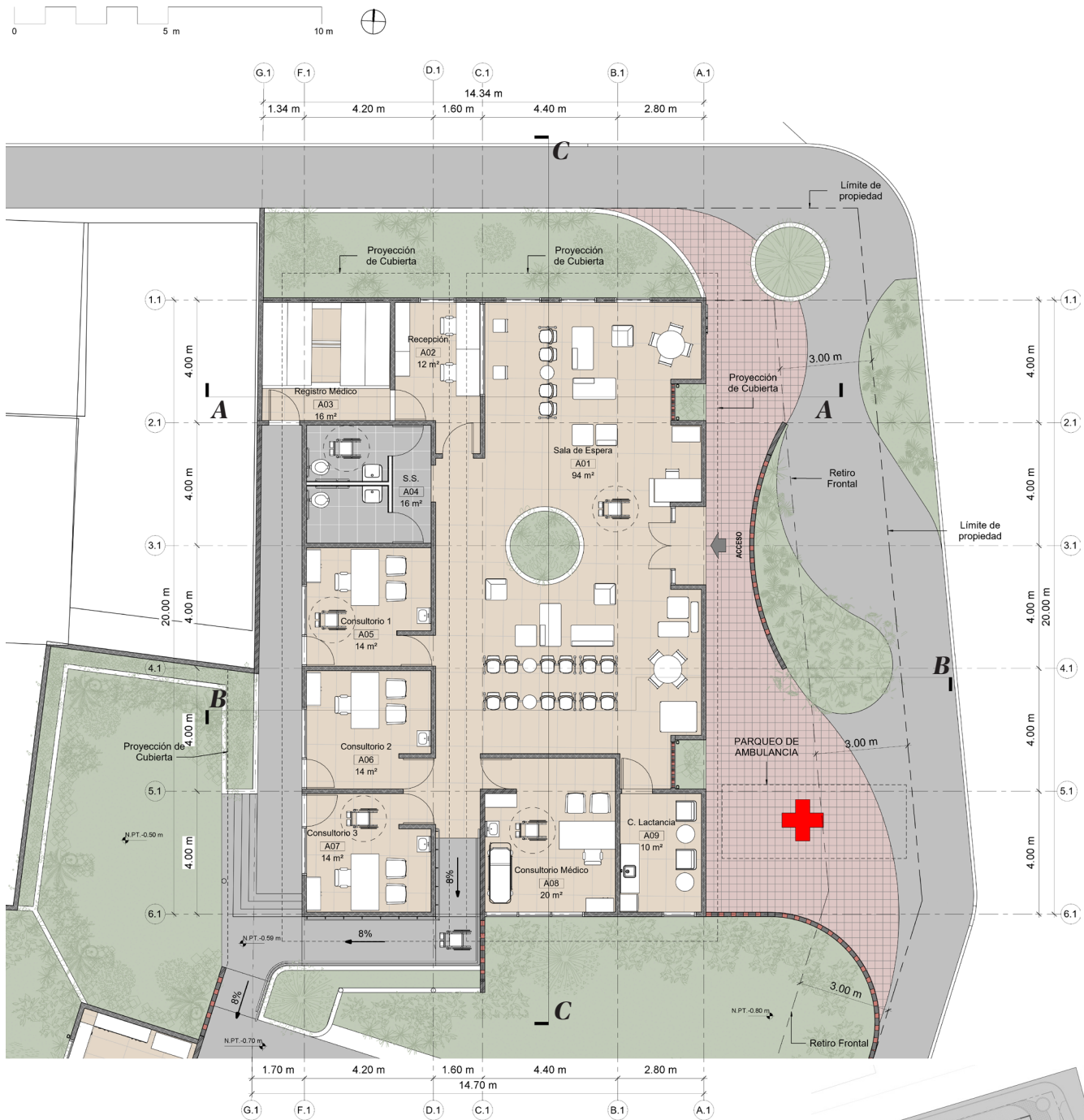
Figura 4.9: Planta Arquitectónica de Volumen 1. Fuente: Elaboración propia
