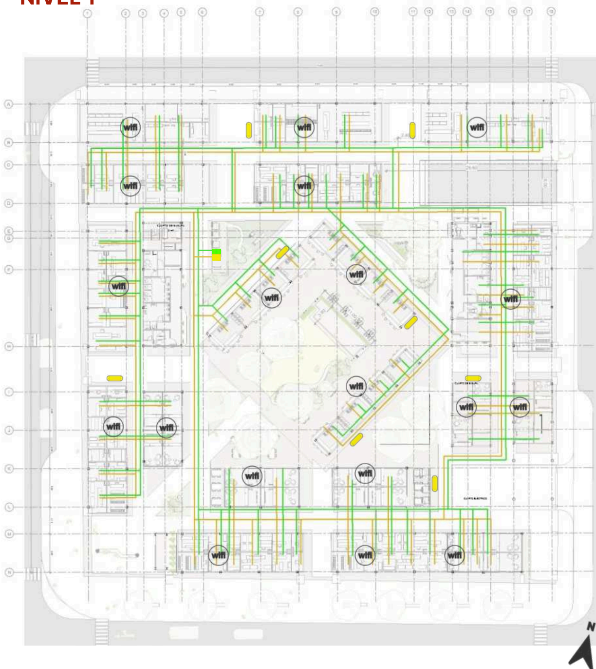
Figura 78. Rutas electricas Nivel 1. (Fuente propia, 2025).
