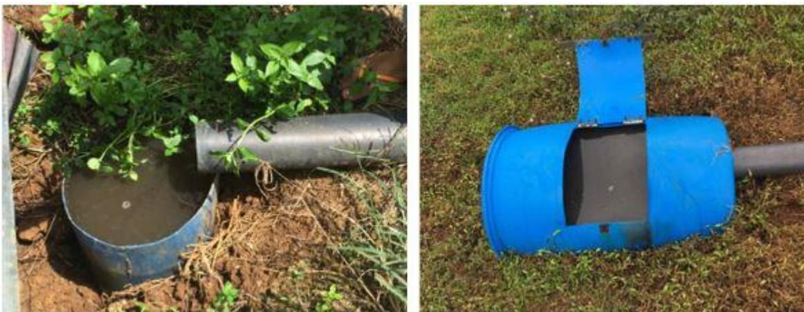
**Figura 5-10. Recipientes utilizados para el almacenamiento de biol.**
