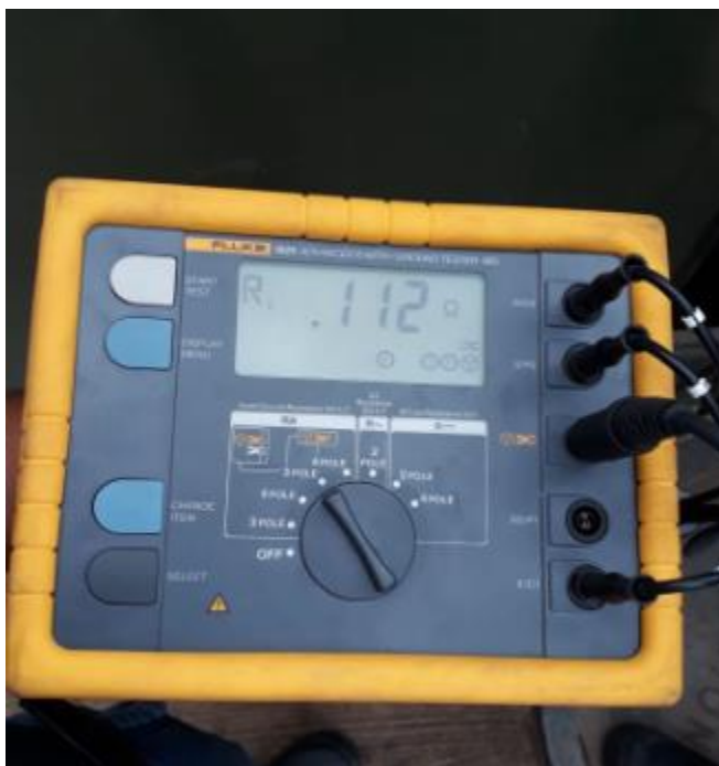
Figura 35. Valor de medición de resistencia de puesta a tierra
