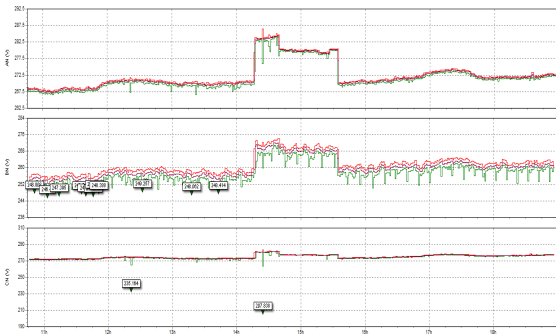
Figura 1. Tensiones medidas en el secundario de transformador Y-Y 34500/480V en Laboratorios STEIN
