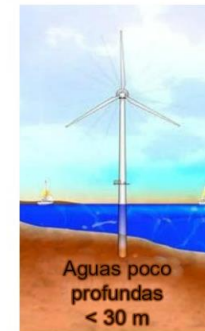
Figura 2. Esquema de la estructura de una torre en un PrEM eólico marino. Fuente: BOEM, (2017).
