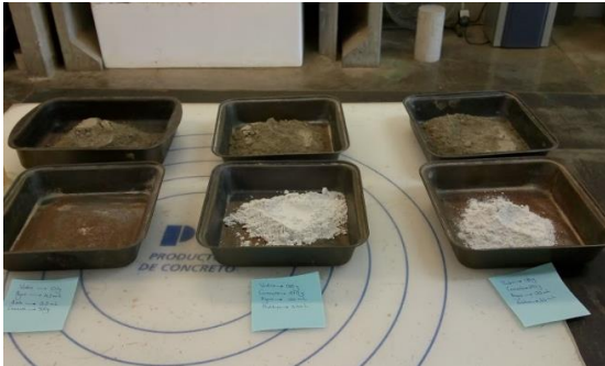
Figura 23: Materiales cuantificados para la realización de la prueba de flujo.
