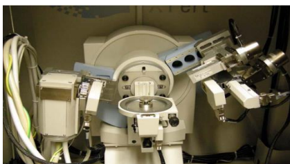
Figura 6: Máquina para difracción de rayos X. Fuente propia, equipo de laboratorio.
