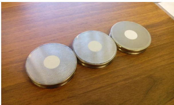
Figura 62: Preparación de muestras de material vítreo para estudio de difracción.
