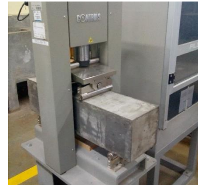
Figura 25: Falla de vigas a flexión
