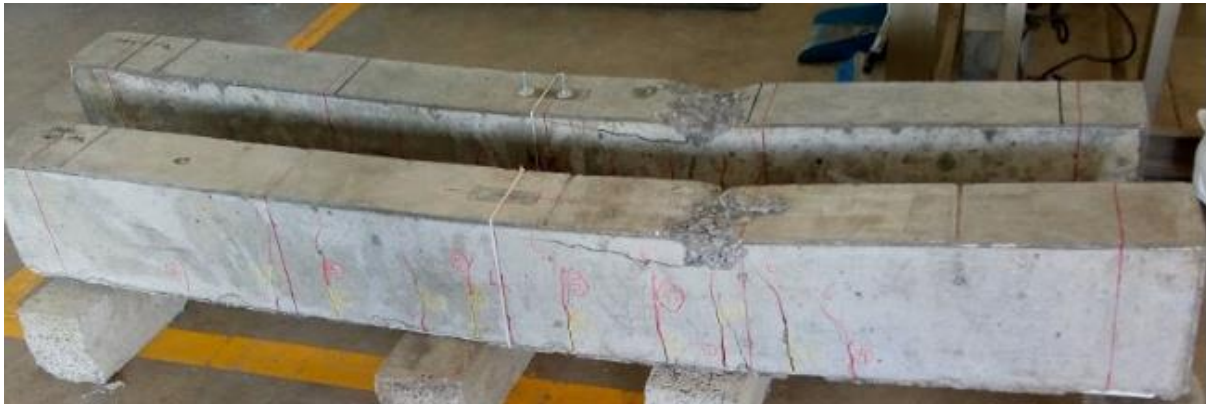
Figura 84: Vigas de concreto reforzadas una vez culminado el ensayo.
