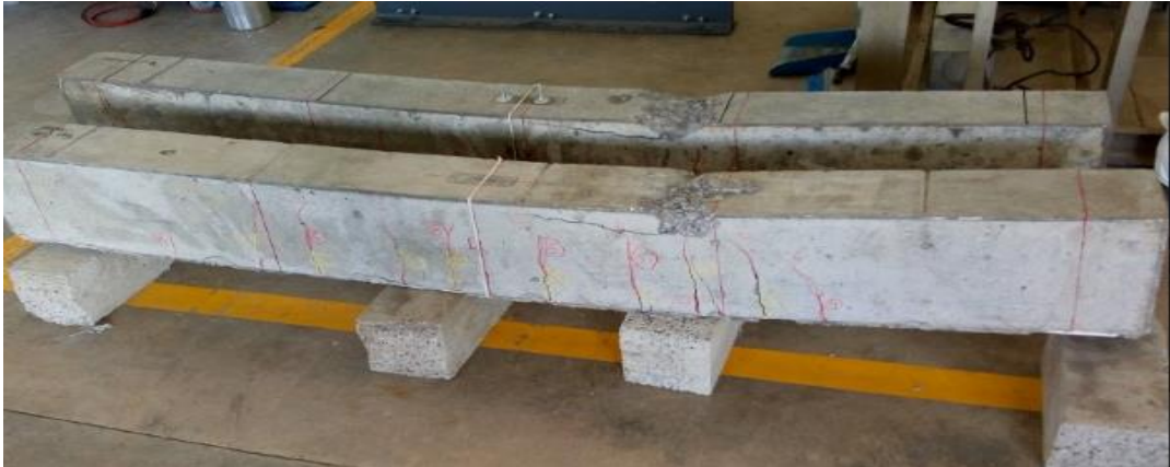
Figura 81: Vigas después de ensayo de falla
