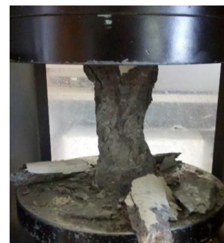
Figura 9: Falla de resistencia a la compresión de un cilindro CAD a 28 días.
