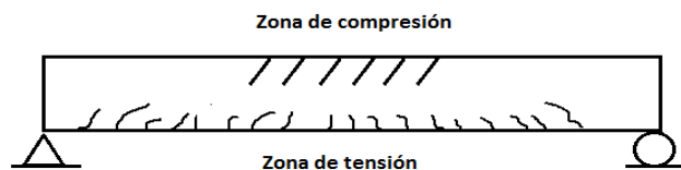
Figura 13: Comportamiento flexionante longitudinal de vigas de concreto reforzado
