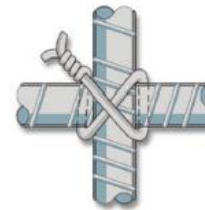
Figura 17: Amarre de acero de refuerzo longitudinal y de confinamiento.
