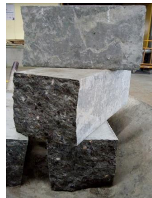
Figura 73: Elementos fallados para determinación de módulo de ruptura
