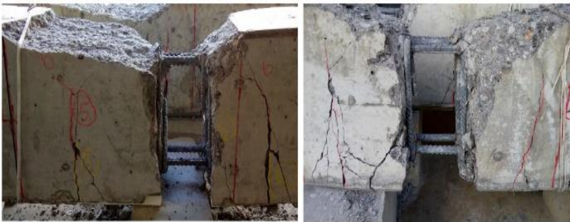
Figura 87: Acero y grietas de falla en viga de concreto con material vítreo versus sin material vítreo.
