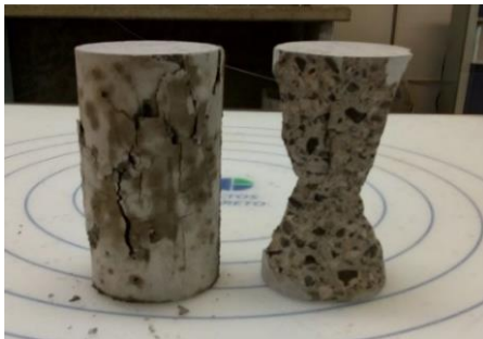
Figura 68: Especímenes ensayados a resistencia a la compresión a 7 días de edad.
