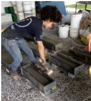
Figura 57: Elaboración de las vigas de concreto hidráulico
