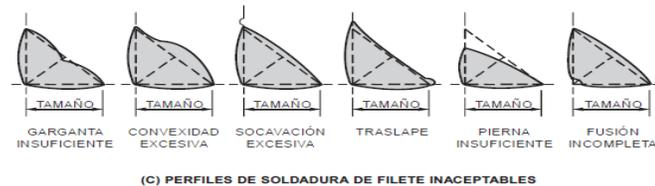
**FIGURA 21.** Perfiles de Soldadura Inaceptables para Soldaduras a Filete.
