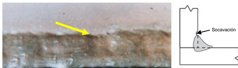
**FIGURA 13.** Socavación.
