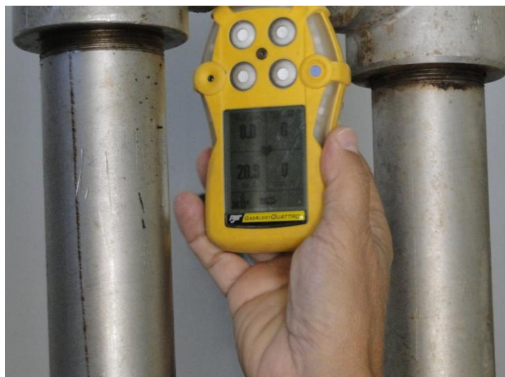
Figura 3.9 Medición de presencia de pentano
