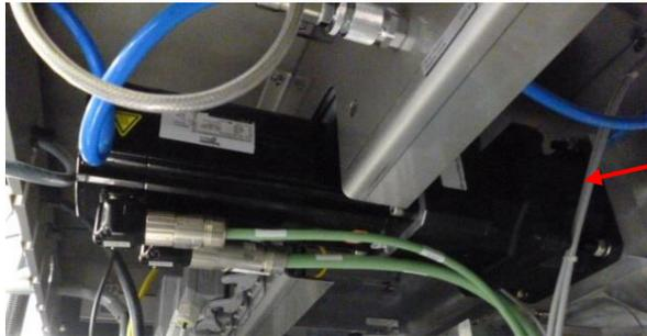
9.2.17. Verificar que no existan fugas en las conexiones de las mangueras de agua refrigerada (1) en la estación de moldeo, en el manifold del agua (2) y en las mangueras de soplado (3). Corregir si hay fugas. Soplar el filtro de escape (4), si está de otro color (amarillo) sustituirlo.
