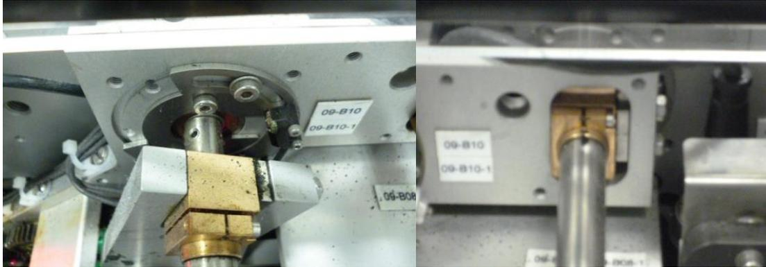
9.15.4. Limpiar los ejes y los sensores de posición cero.
