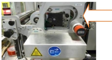
9.11.2. Desmontar tapa del mecanismo entintador (2). Revisar que los tornillos no estén barridos.
