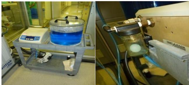
9.19.15. Revisar que no tenga fugas la válvula de drenaje del tanque de prueba de integridad, ubicado en la parte inferior del mismo. Reportar.
