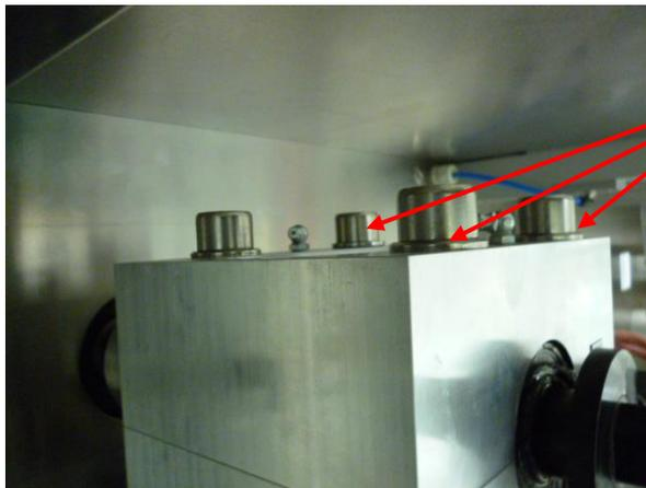
9.2.15. Revisar que no haya polvo por desgaste en el acople tipo estrella, si existe desarmar y verificar acople. Reportar si existe desgaste o ruptura.
