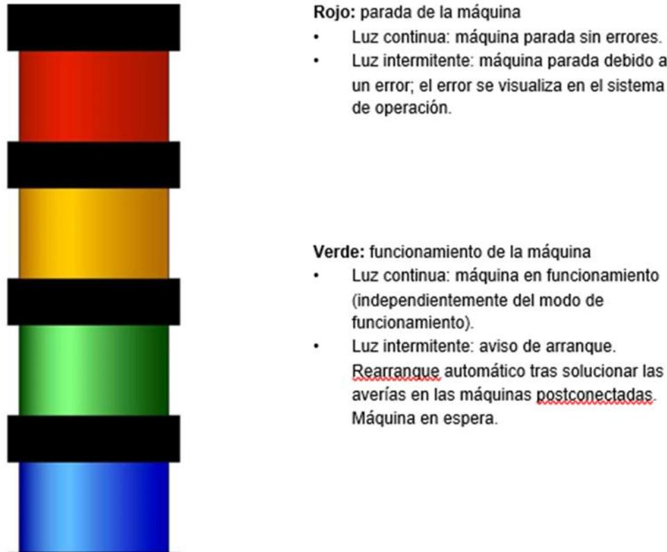
Figura 23. Significado de los estados que muestra la columna luminosa de las Uhlmann B1330.
