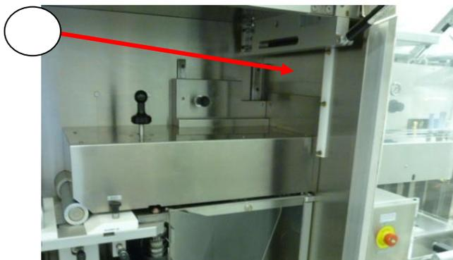
9.10.11. Limpiar filtro de vacío (1) de la transferencia. Cambiar si está de color amarillo o gris.
