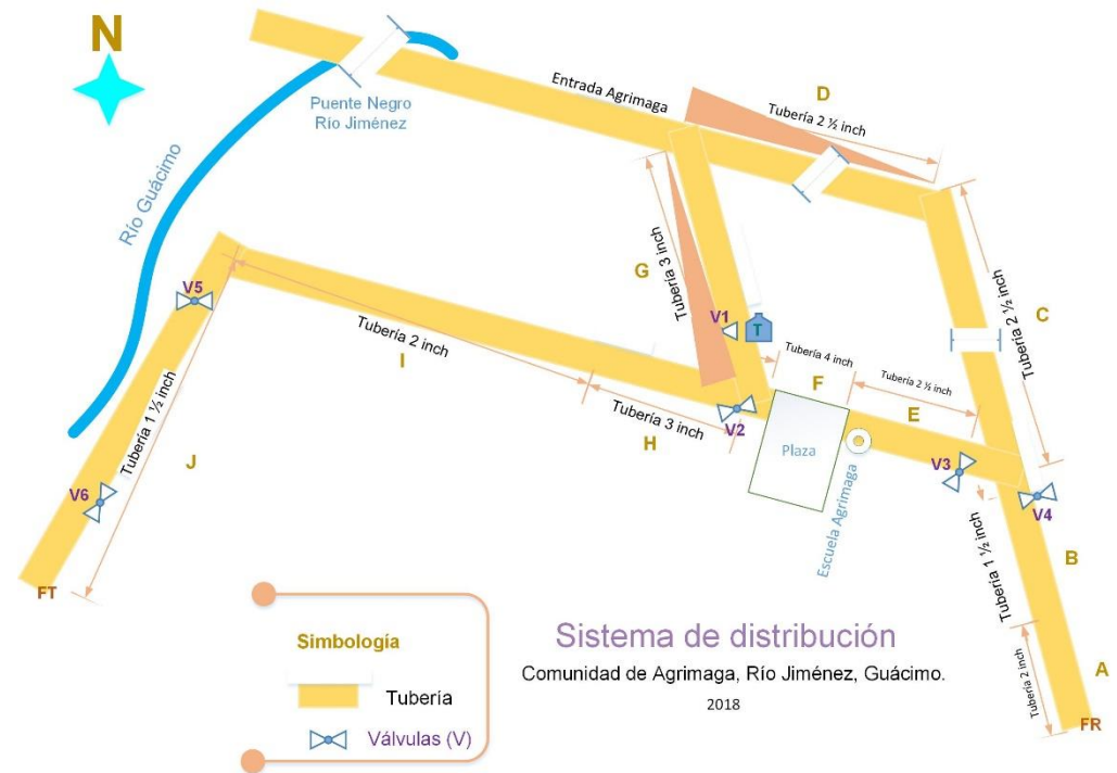
Figura 2. Croquis del sistema de distribución de la ASADA Agrimaga. Elaboración propia, utilizando Visio 2016.
