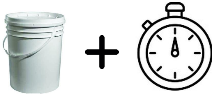
Figura 4. Equipo necesario para realizar el aforo volumétrico en el sistema de pozo.
