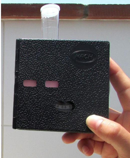
Figura 11. Resultado de la evaluación de una muestra de agua, para determinar la concentración de cloro. Tomado de https://latam.hach.com/ .
