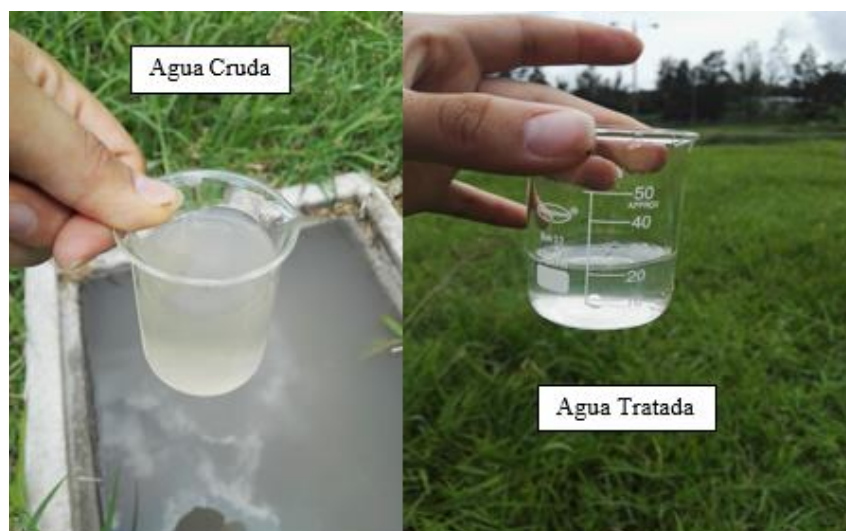
Figura 5.10. Remoción de SST a partir de los tanques sépticos modificados.
