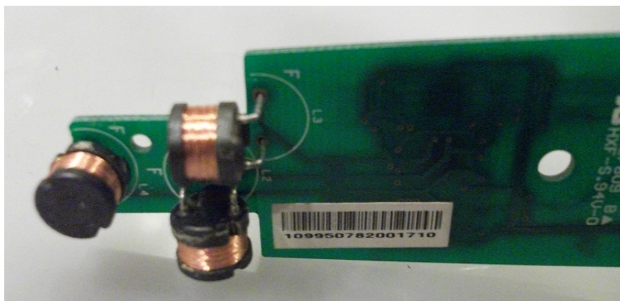
FIGURA 4.8: Bobinas en un sensor del Razer Hydra ( WiredEarp, 2011 )
