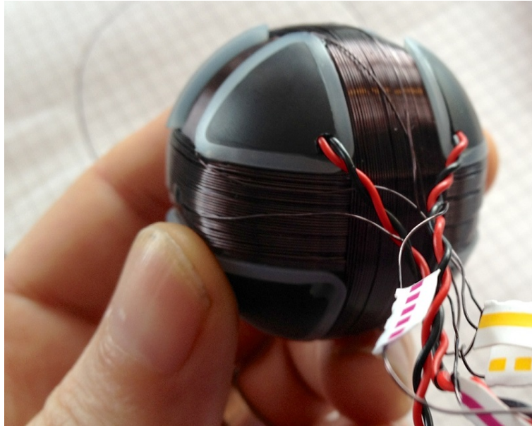
FIGURA 4.7: Bobinas en la base del Razer Hydra ( Matthews, 2013 )
