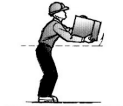
Figura VI-13. Lineamiento de levantar cargas, forma de levantar más alto de los hombros.
