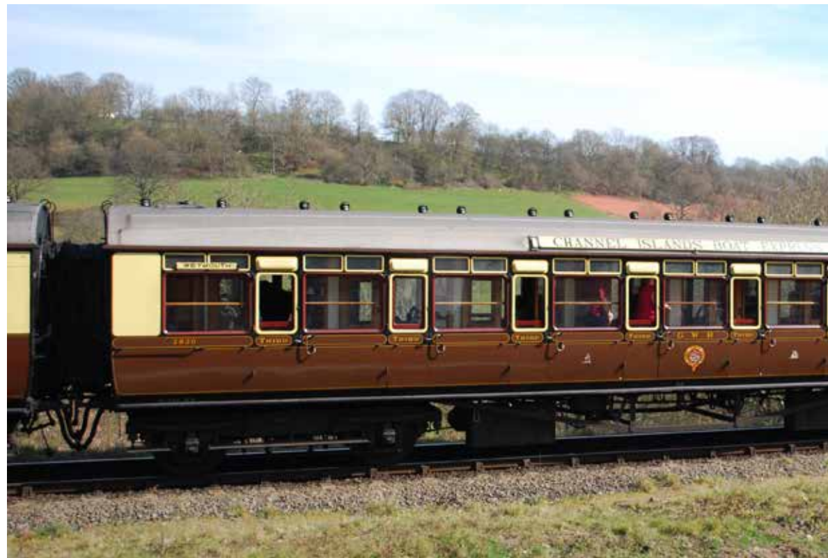
GWR Churchward 57 "Toplight" Corridor Tercer No.8930, como se conserva en el ferrocarril del valle de Severn. Se puede observar la conexión de tipo fuele en uno de los extremos del vagón.
