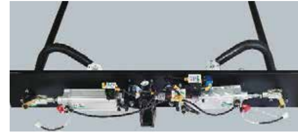
Puertas de dos hojas de medio giro externo, accionadas por un sistema neumático, con controlador eléctrico.
