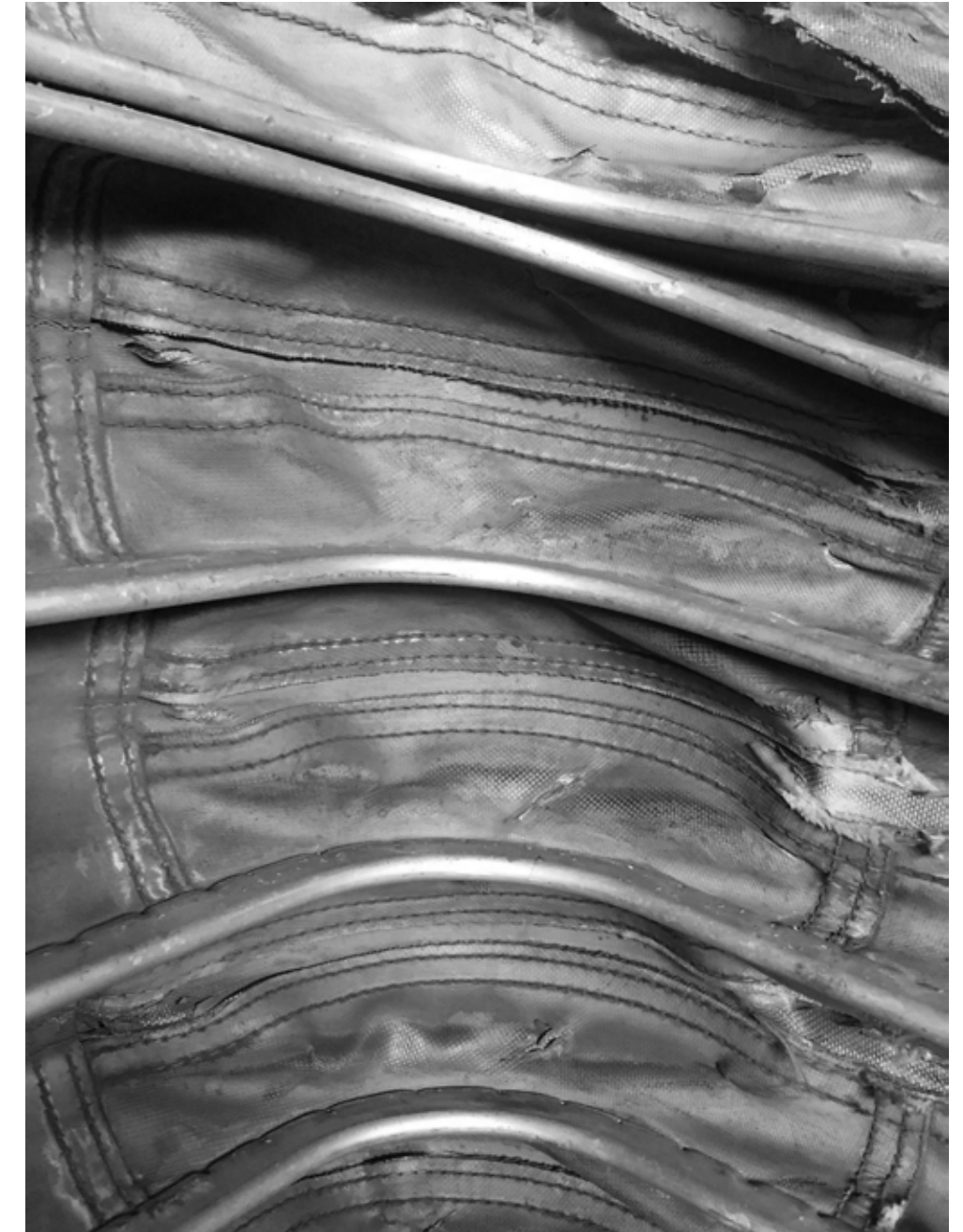
Los principales desgastes sufridos por estos componentes se dieron en el material flexible, un material compuesto entre polímero y textiles, cocido en las esquinas. La vida útil de estos acordeones fue de más de 15 años. ¡0 años en España y 5 en el país. Esto sin contar aquellos acoples que fueron dañados en descarrilamientos o colisiones.
