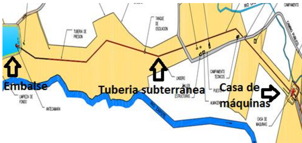
Figura 4.2 Transporte del agua hacia casa máquinas. [5]
