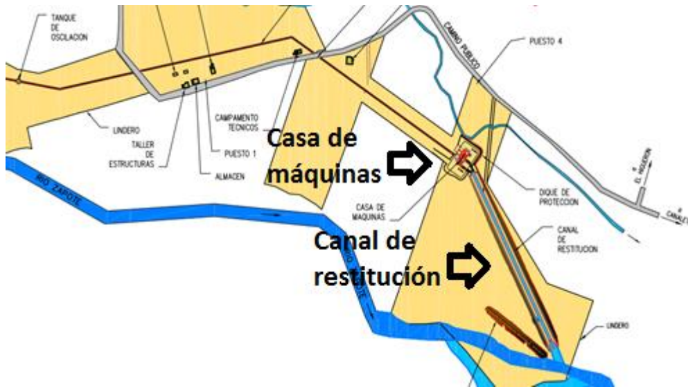
Figura 4.3 Regreso del agua al cauce del río [5]
