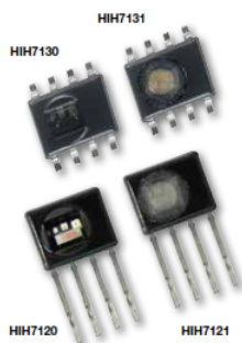
Figura 3.7: Sensor de temperatura HIH7000 [6]
