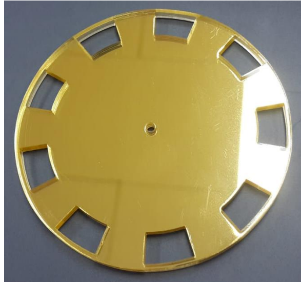
Figura 3.6 Esquemático y resultado de disco codificador (versión 3)
